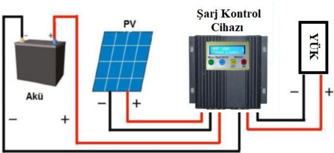
Şekil 6.1. Tezde kullanılan sistemin, (a)prensip şeması, (b)fotoğraf görüntüsü (devamı)
