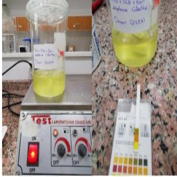
Şekil 3.8 \text{TiO}_2 + \text{SiO}_2 + \text{B}_2\text{O}_3 Kaplama Karışımının Hazırlığı ve pH Derecesi.
