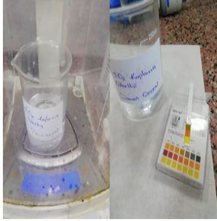
Şekil 3.7 SiO 2 Kaplama Karışımının Hazırlığı ve pH Ölçümü.
