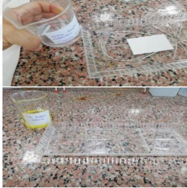
Şekil 3.10 \text{TiO}_2 , \text{SiO}_2 , \text{B}_2\text{O}_3 ve \text{TiO}_2 + \text{SiO}_2 + \text{B}_2\text{O}_3 Sol – Jel Daldırma Yöntemi ile Kaplama.
