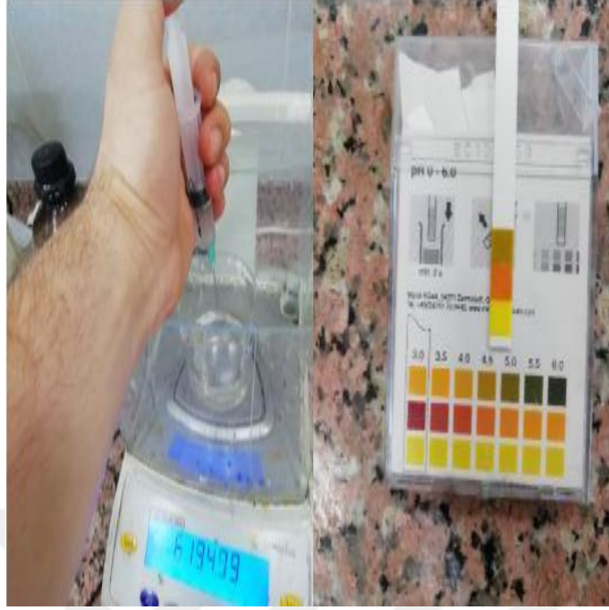
Şekil 3.6 \text{TiO}_2 Kaplama Karışımının Hazırlığı ve pH Ölçümü.
