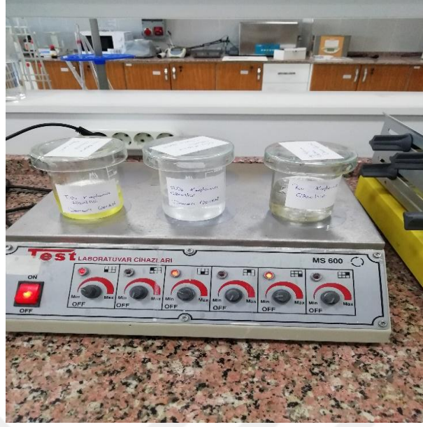
Şekil 3.9 Karışımların Manyetik Karıştırıcıda Karıştırılması.
