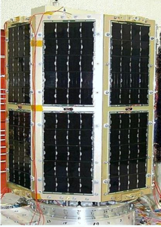
Resim 1.2. MidSTAR-1 uydusunun Galyum Arsenit güneş panelleri (Akbulut, 2015)
