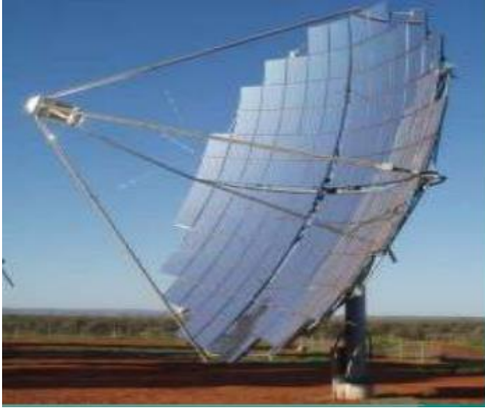
Resim 1.3. Nokta odaklı güneş kollektörü (Cezim, 2013)
