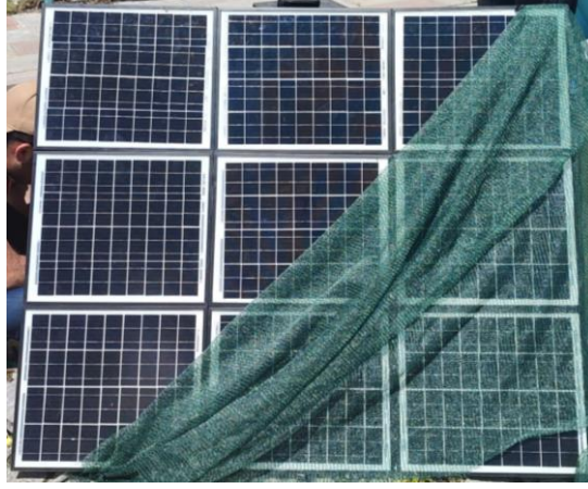
Şekil 72. G13 senaryosunda FV dizisi (Işıma: 828 \text{ W/m}^2 , Gölge: 50 - 400 \text{ W/m}^2 )
