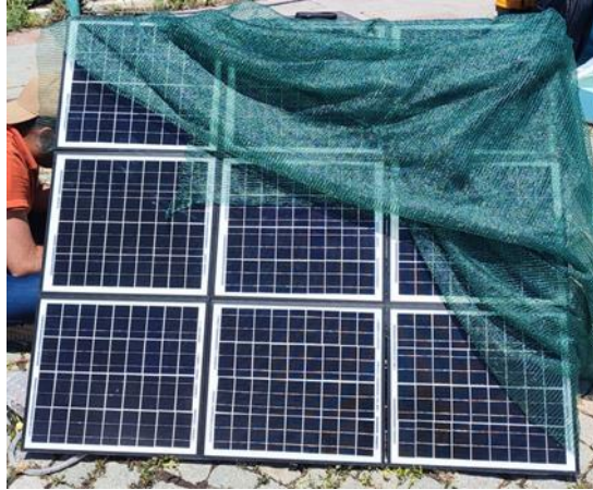
Şekil 64. G11 senaryosunda FV dizisi (Işıma: 848 \text{ W/m}^2 , Gölge: 50\text{--}400 \text{ W/m}^2 )
