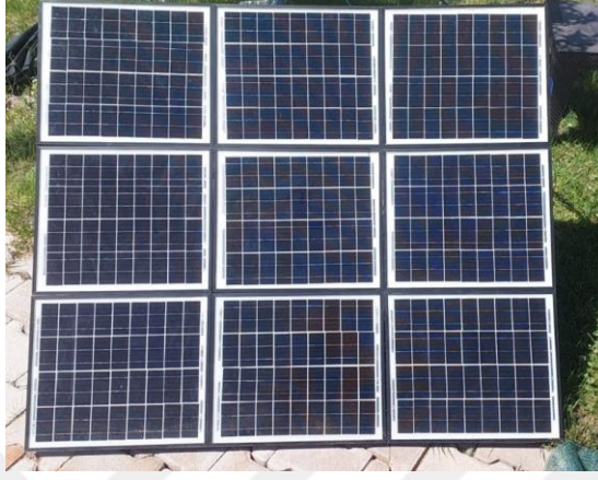
Şekil 54. G8 senaryosunda FV dizisi (Işıma: 710 \text{ W/m}^2 , Gölge: yok)
