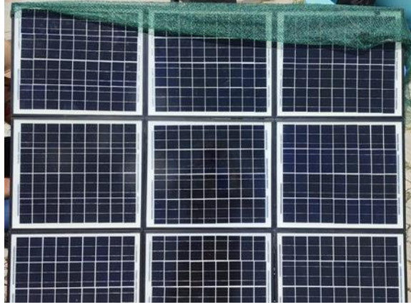
Şekil 60. G10 senaryosunda FV dizisi (Işıma: 840 \text{ W/m}^2 , Gölge: 320 \text{ W/m}^2 )
