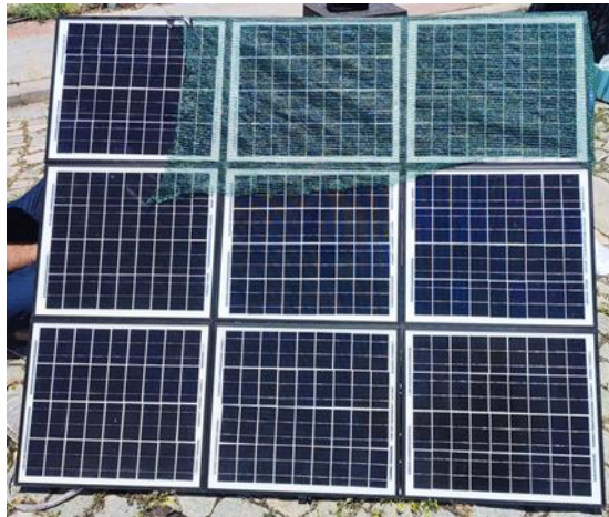
Şekil 68. G12 senaryosunda FV dizisi (Işıma: 856 \text{ W/m}^2 , Gölge: 420 \text{ W/m}^2 )
