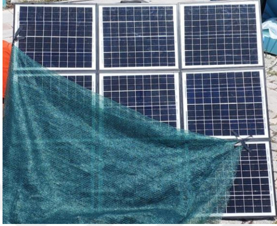
Şekil 76. G14 senaryosunda FV dizisi (Işıma: 832 \text{ W/m}^2 , Gölge: 150 \text{ W/m}^2 )
