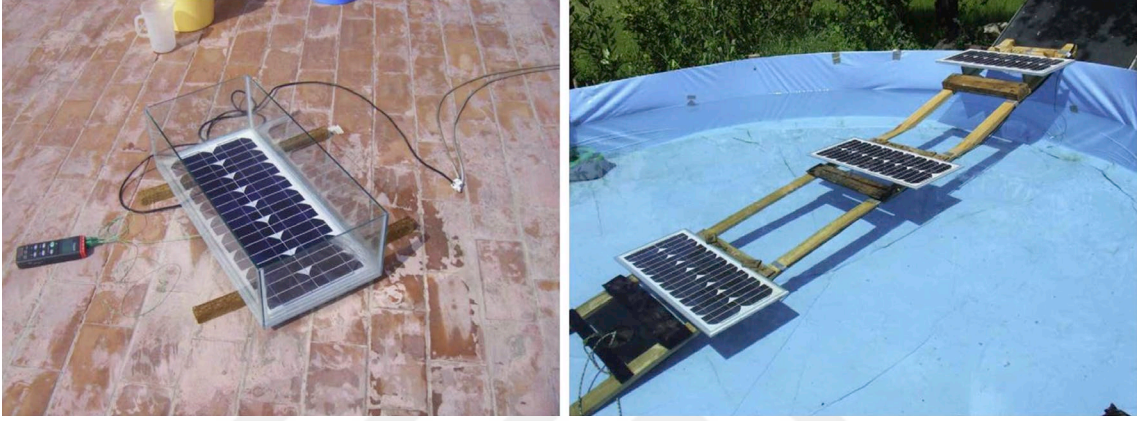
Şekil 5.3. Su ile pasif soğutma – daldırma yöntemi [156]
