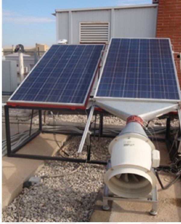
Şekil 5.12. Hava ile aktif soğutma çalışması [168]
