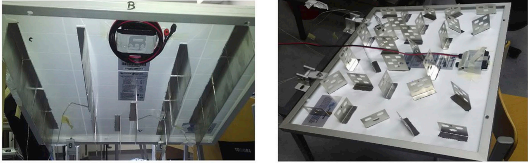
Şekil 5.1. İki farklı L-profil kanatla pasif soğutma [154]
