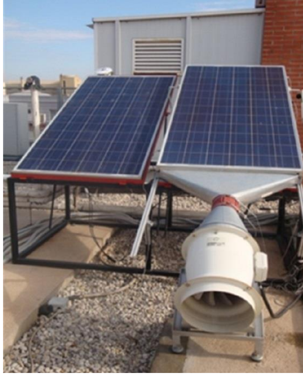
Şekil 5.12. Hava ile aktif soğutma çalışması [168]
