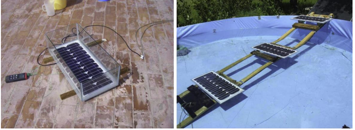
Şekil 5.3. Su ile pasif soğutma – daldırma yöntemi [156]
