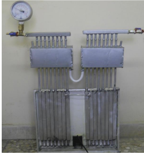
Şekil 5.5. Isı borusu ile pasif soğutma içeren PV/T uygulaması [160]
