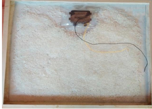
Şekil 5.6. PCM ile pasif soğutma uygulaması [161]
