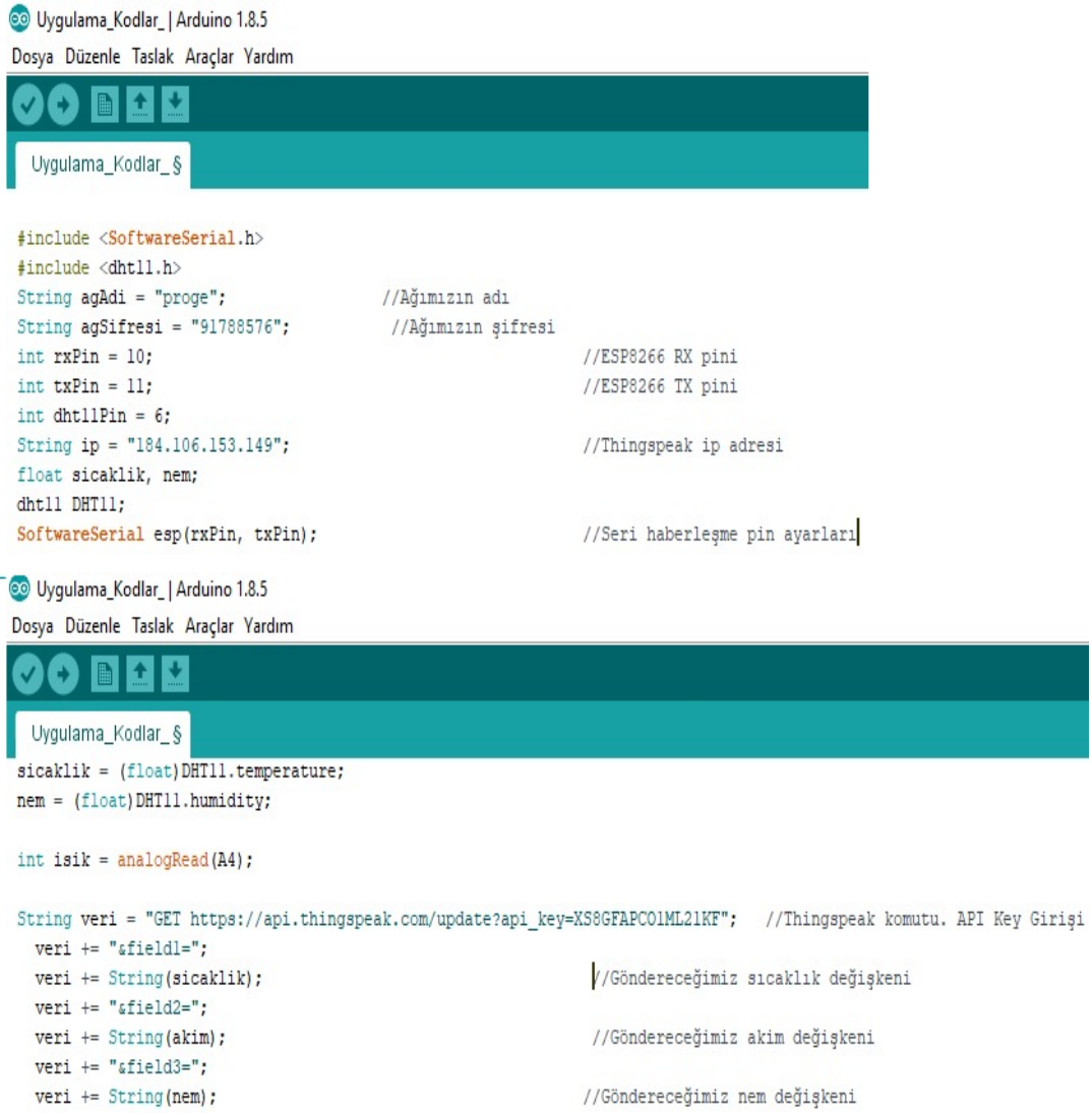
Resim 3.4. Arduino IDE kodunda ThingSpeak eşleştirilmesi
