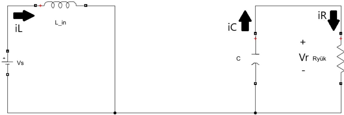
Şekil 3.4 MOSFET iletimde olduğu durum
