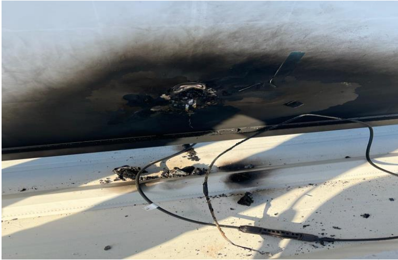
Şekil 4.11. Kablolama hatası sonucu oluşan yanmalar
