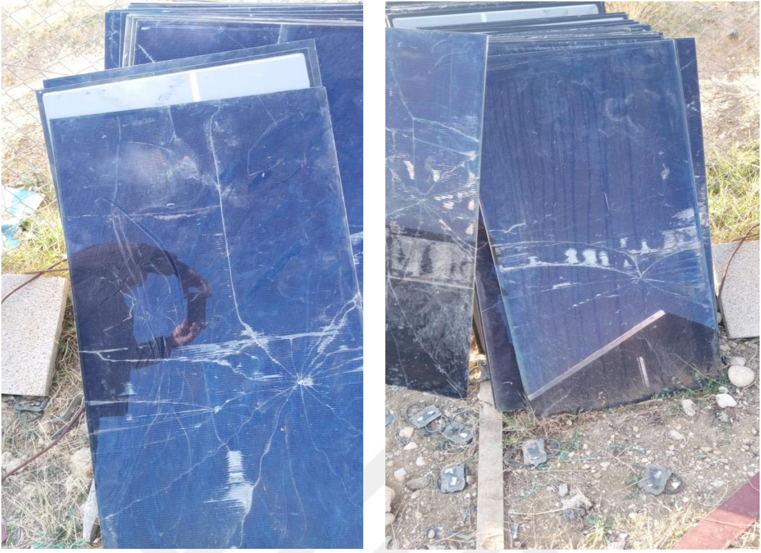
Şekil 4.18. Dış etkenlerden dolayı kırılmış paneller
