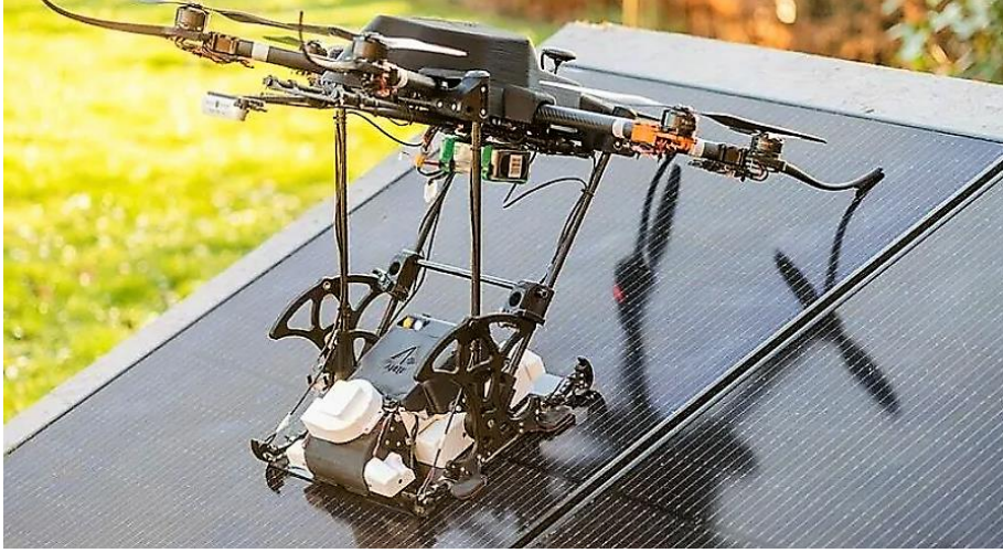
Şekil 4.4. Tozlanmanın drone ile temizlenmesi (URL-26, 2022)
