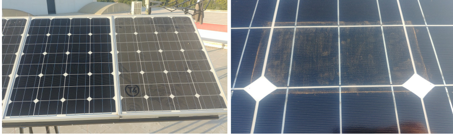
Şekil 5.15. Temiz ve tozlu panel – Tozlandırılmış hücre
