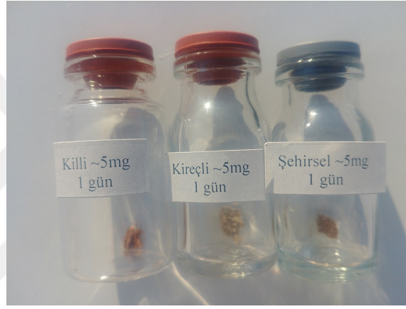
Şekil 5.13. 1 günlük yapay tozlandırma için toz numuneleri
