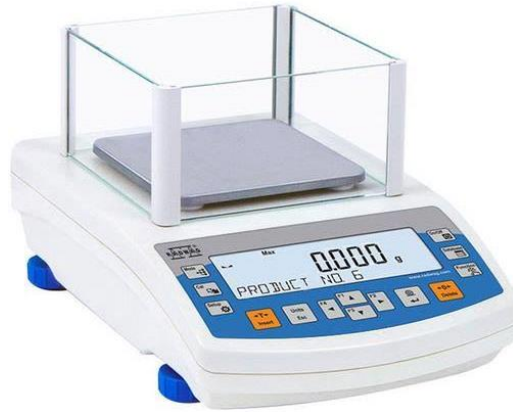
Şekil 5.6. Hassas terazi (RADWAG PS 1000.R2)
