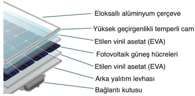
Şekil 3.2. Fotovoltaik panelin fiziksel yapısı [95]
