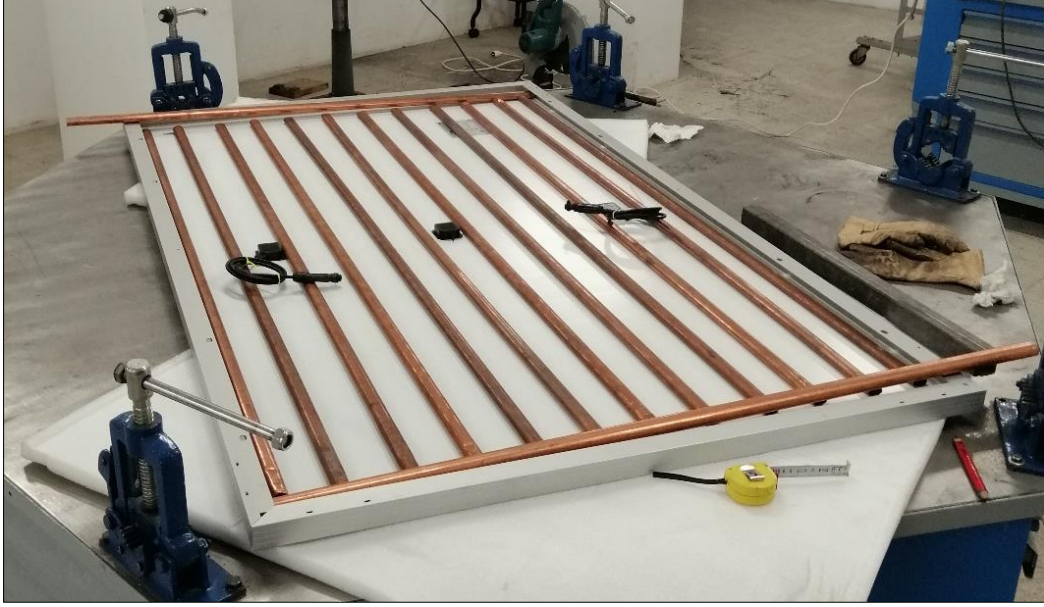
Resim 4.3. Soğutucu serpantin ve PV panel montaj süreci
