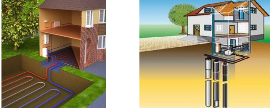
Şekil 1.3. Boruların yatay ve dikey yerleşimi (Anonim-2, 2020)
