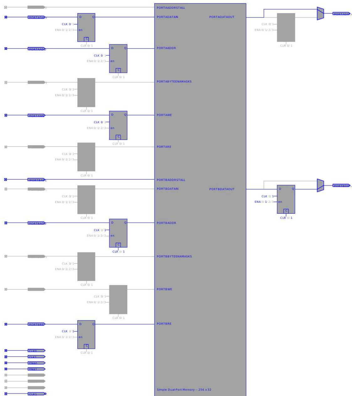
Şekil A.2: M9K hafıza bloğu konfigürasyon örneği
