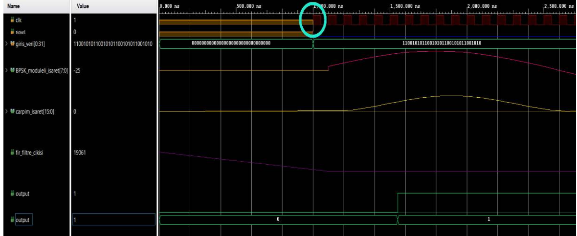
Şekil 44. rising_edge_clk = '1', trailing_edge_clk = '0' ve reset = '0' olduğunda, giriş_veri:= [11001010110010101100101011001010] için benzetim sonucu
