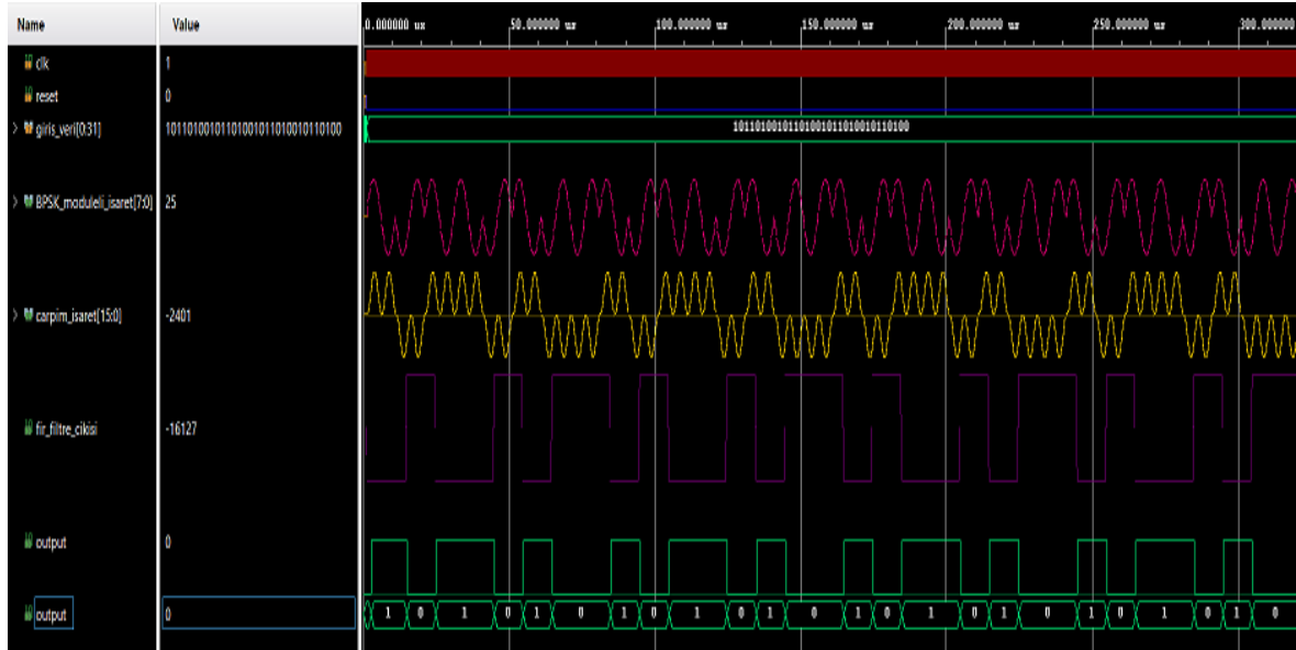
Şekil 39. rising_edge_clk = '1', trailing_edge_clk = '0' ve reset = '0' olduğunda, giriş_veri:= [10110100101101001011010010110100] için benzetim sonucu
