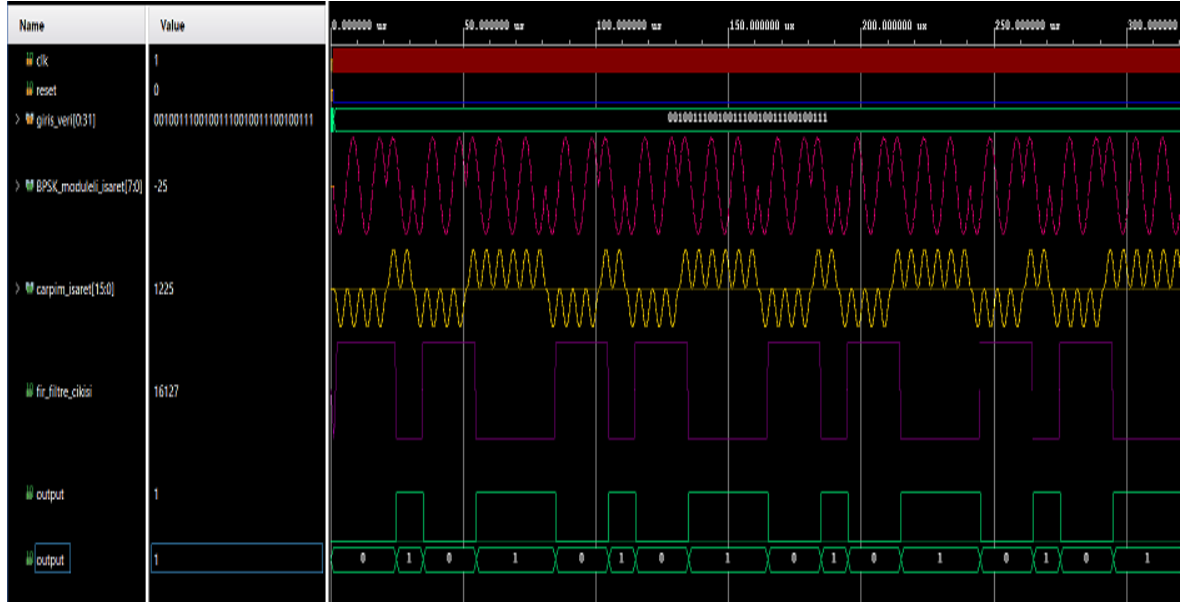
Şekil 41. rising_edge_clk = '1' , trailing_edge_clk = '0' ve reset = '0' olduğunda, giriş_veri:= [00100111001001110010011100100111] için benzetim sonucu
