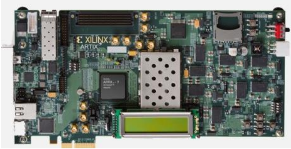
Şekil 3.5 Xilinx Artix-7 FPGA kartı.
