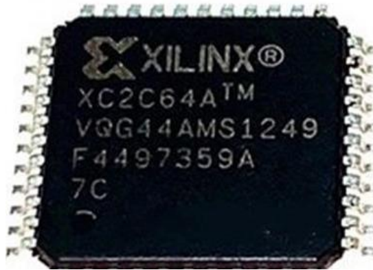
Şekil 3.17 XILINX XC2C64A-7-VQ44 numaralı FPGA çipi.
