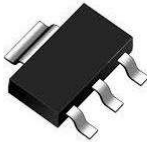
Şekil 3.19 SOT-223 paket Regülatör (Linear Technology Corporation 2002).
