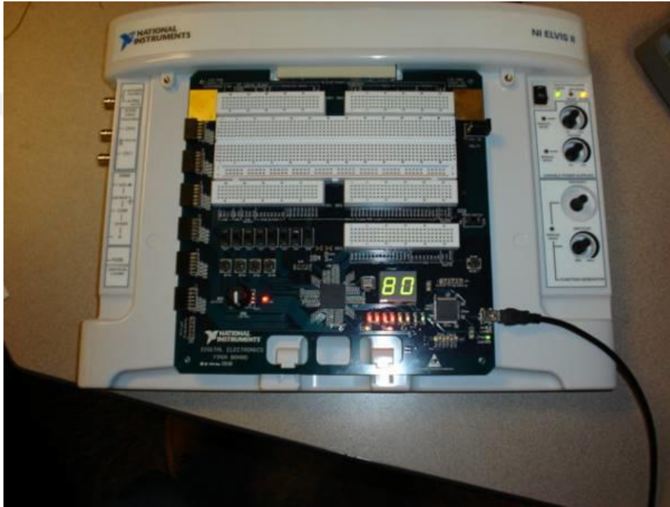
Resim 2. 1 Ursutiu ve arkadaşları tarafından yapılan çalışmada kullanılan NI-ELVIS platformu (Ursutiu vd. 2009)
