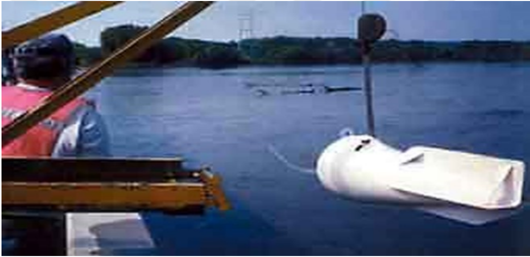
Şekil 2.2. USD-49 Yöntemi ile sediment ölçümü
