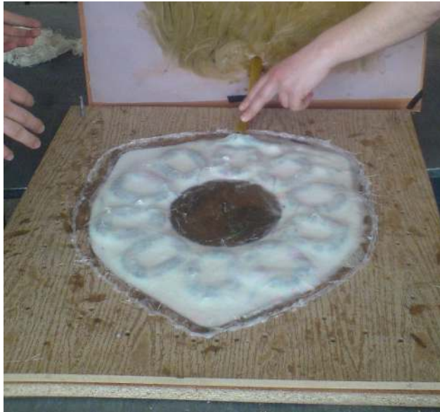
Resim 1.7. Epoksi döküldükten sonra statorun görünümü
