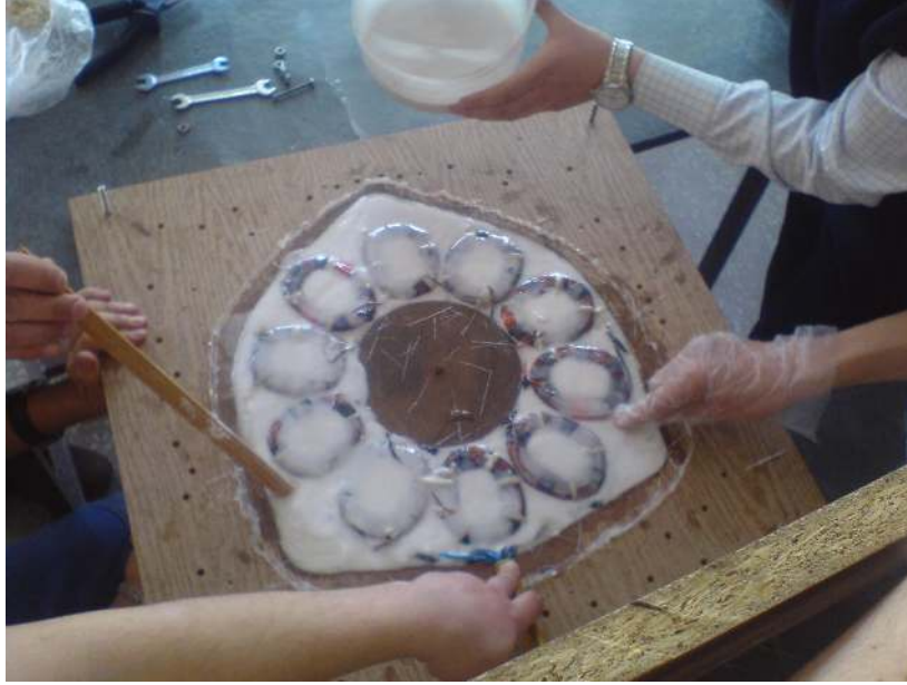
Resim 1.6. Epoksinin kalıba dökülmesi
