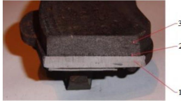
Şekil 2.2. Önemli fren balatası bileşenleri: 1- arka plaka, 2- alt katman, 3- sürtünme malzemesi (Borawski, 2020)
