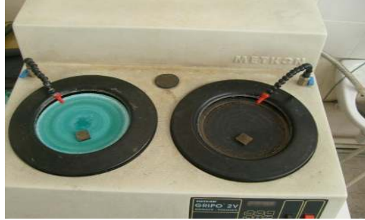
Resim 3.17 Numune parlatma cihazı.
