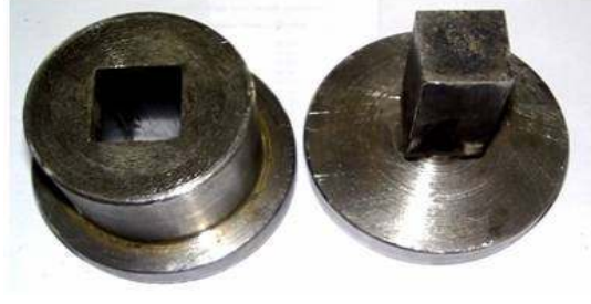
Resim 3.3 Deney numunelerinin üretildiği soğuk presleme kalıbının görünüşü.
