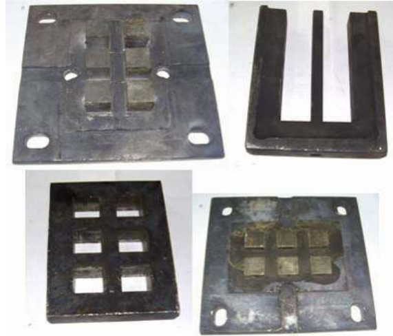
Resim 3.5 Deney numunelerinin üretildiği sıcak presleme kalıbı.
