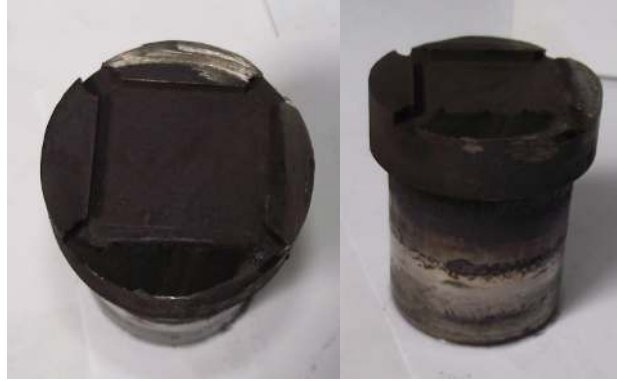
Resim 3.8 1 inçlik balata tutucu piston.
