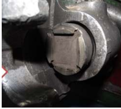
Resim 3.16 Fren balatası test cihazında kullanılan özel olarak yapılmış kaliper pistonu.
