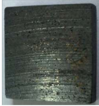
Resim 4.1 Sürtünme deneyi sonrasındaki numune yüzeylerindeki aşınma izleri.
