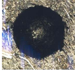
Resim 3.22 Numune üzerindeki Brinell sertlik izi.
