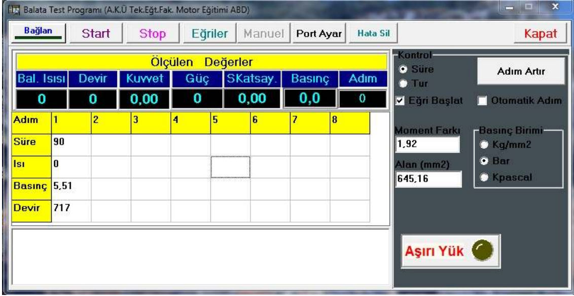
Resim 3.10 Fren balatası test cihazı otomatik kontrol paneli.
