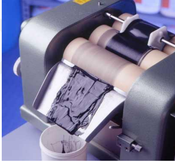
Resim 3.2 Emaye karışımının üçlü ezmeden geçirilmesi.
