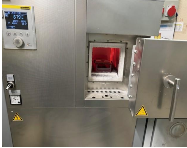
Resim 3.4 Kaplamalı cam altlıklara ısıtıl işlem uygulanması.
