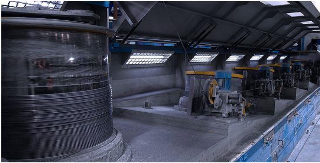
Şekil 5.3 Fırın Izgarası İçin Tel Çekme İşlemi
