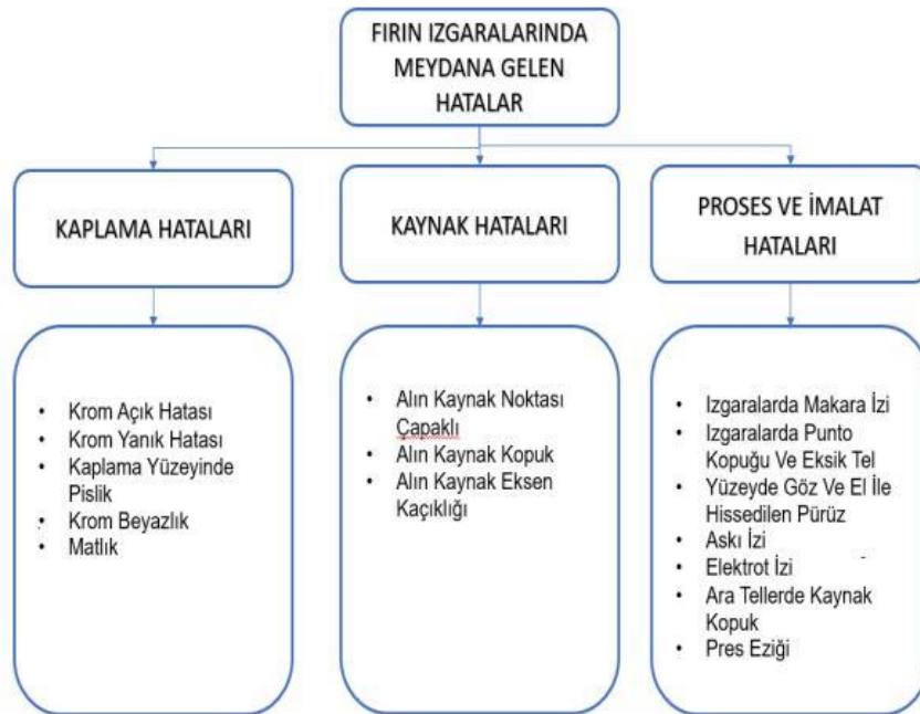
Şekil 5.7 Fırın Izgaralarında Meydana Gelen Hatalar
