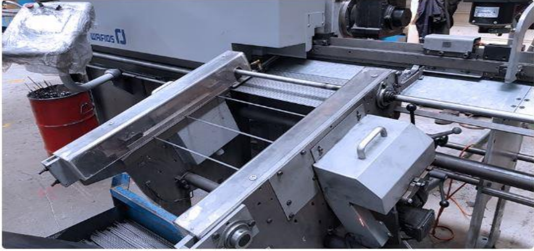
Şekil 5.4 Fırın Izgarası İçin Tel Kesme İşlemi
