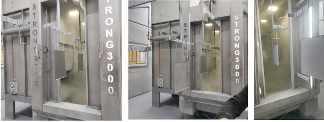
Resim 4.4. Lacivert emaye kaplama işlemine giren deney parçaları
