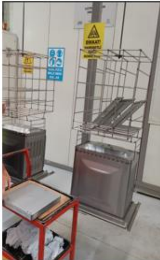
Resim 4.3. Yıkamadan çıkan, kurutma fırınına giren deney parçaları
