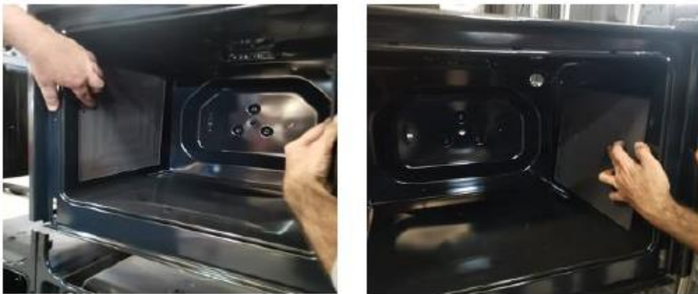
Resim 4.18. Katalitik yan panel sacların fırına montajı
