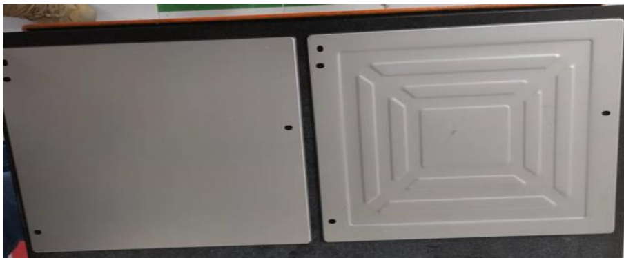
Resim 4.2. Deneysel çalışmada kullanılan sac malzemeler (emaye proses öncesi)
