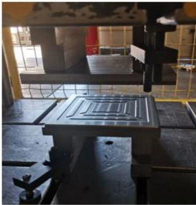
Resim 4.1. Hidrolik pres makinesinde parça yüzeyine form verme işlemi
