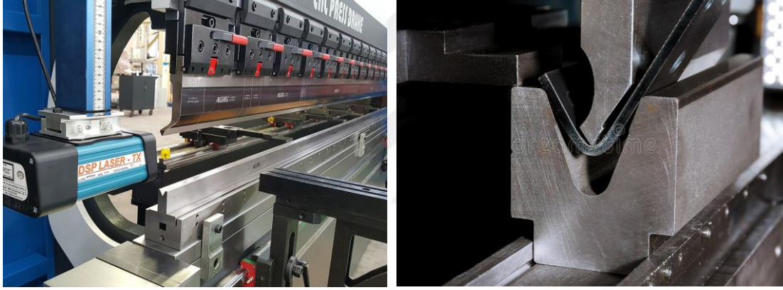
Şekil 2.13. CNC pres (abkant pres) – abkant pres kalıbı
