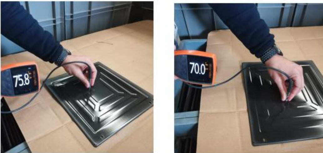
Resim 4.6. Lacivert emaye kaplamanın kalınlığı ( \mu\text{m} )
