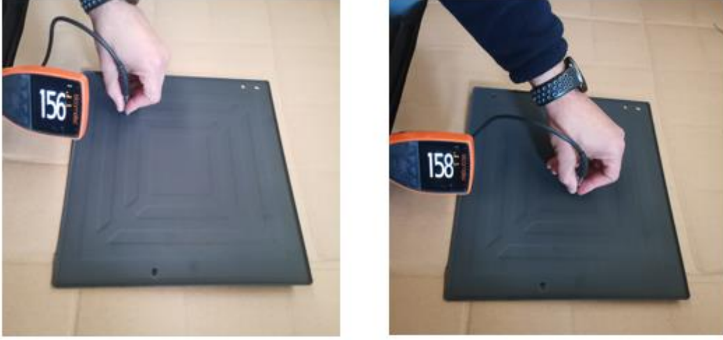
Resim 4.9. Katalitik emaye kaplamanın kalınlığı ( \mu\text{m} )
