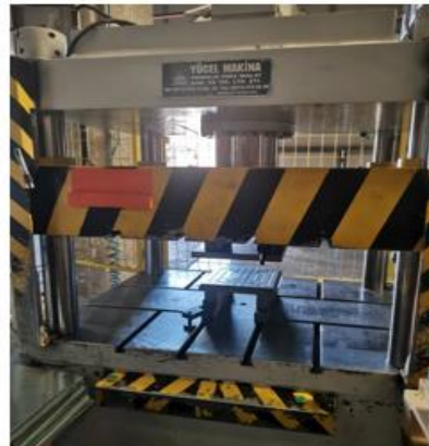
Resim 4.1. Hidrolik pres makinesinde parça yüzeyine form verme işlemi
