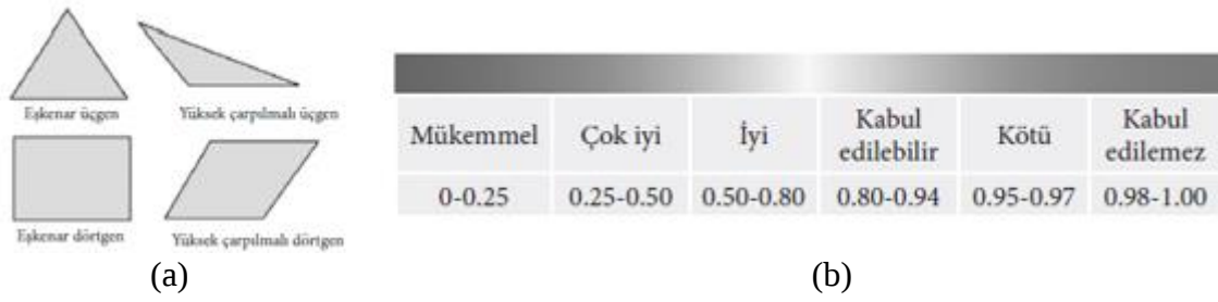
Şekil 4.2. Ağ elemanın ideal geometriden sapması (a), çarpıklık kalite renk çizelgesi (b)
