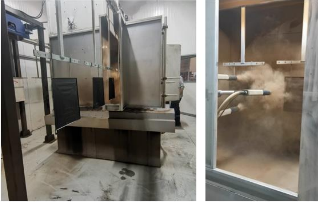
Resim 4.7. Katalitik emaye kaplama işlemi
