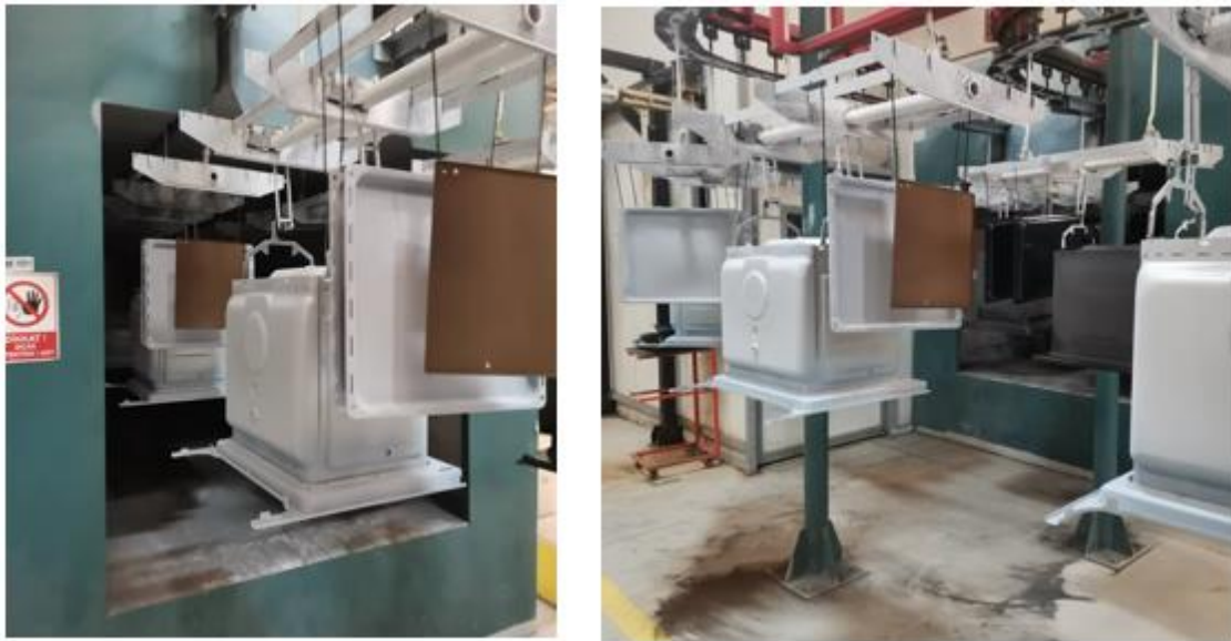
Resim 4.8. Katalitik emaye kaplama sonrası fırınlama işlemi
