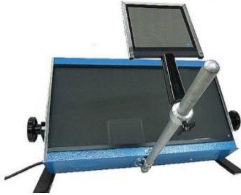
Görsel 3. 9. Cam bünyesindeki gerilmelerin kontrolü için kullanılan Nortel marka polariskop ( http://www.nortelglass.com/polariscopes.shtml Erişim tarihi: 15.03.2019)
