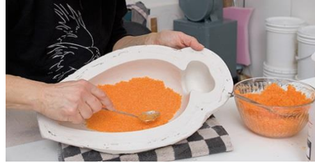
Görsel 1. 12. Cam hamurunun hazırlanan kalıp içerisine uygulanışı ( http://www.bullseyeglass.com/how-do-i-make-pate-de-verre.html )
