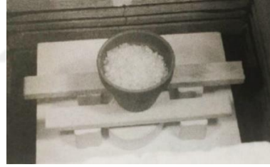
Görsel 1. 21. Potanın sabitlenmesi için fırın içerisine oluşturulan düzenek (Kervin and Fanton, 2000, s. 110)
