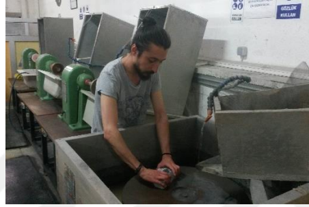
Görsel 3. 17. Yatay aşındırma diski ile cam yüzeyindeki kalıntıların ve derin çiziklerin arındırma aşaması (Murat Paktur fotoğraf arşivi)
