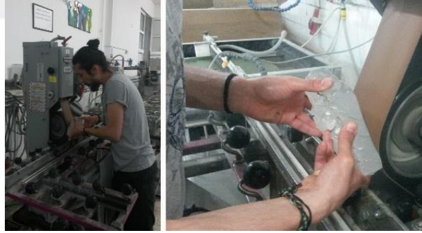
Görsel 3. 18. Farklı kalınlıklardaki şerit bantlar kullanılarak cam yüzeyinin parlatılma aşaması (Murat Paktur fotoğraf arşivi)
