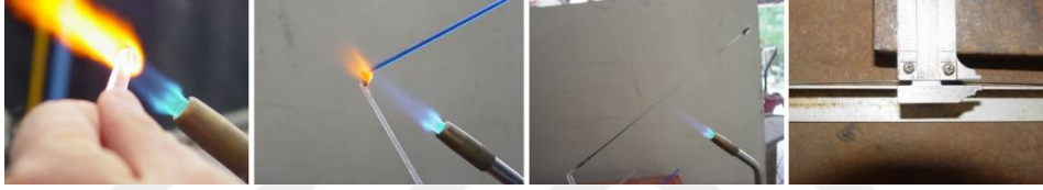
Görsel 2. 19. Şaloma yardımıyla iki farklı camın eritilip çekilerek uyumluluğun test edilmesi ( http://www.davebross.com/GlassTech/glasscompatibilitypage2.html Erişim tarihi: 10.03.2019)
