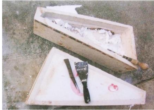
Görsel 1. 32. Açık kalıp yöntemi kullanılarak hazırlanmış refrakter kalıp (Baker, 2010, s. 116)
