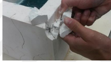
Görsel 3. 15. Fırınlama sonrası cam objenin refrakter kalıp içerisinden çıkartılma süreci (Murat Paktur fotoğraf arşivi)
