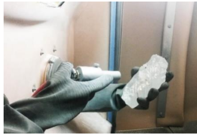
Görsel 3. 16. Cam objenin kalıp kalıntılarının ve yüzey pürüzlüğünün kumlama işlemi ile temizlenmesi (Murat Paktur fotoğraf arşivi)
