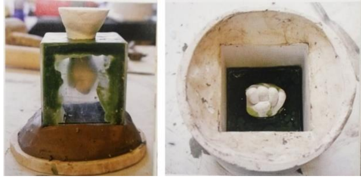
Görsel 1. 35. Sabit maçalı (çekirdek) kalıp (Thwaites, 2011, s. 81)
