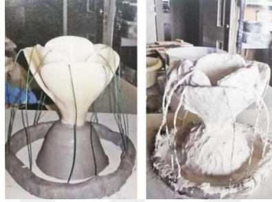
Görsel 1. 5. El ile sıvama refrakter kalıplama yöntemi (Thwaites, 2011, s. 70)
