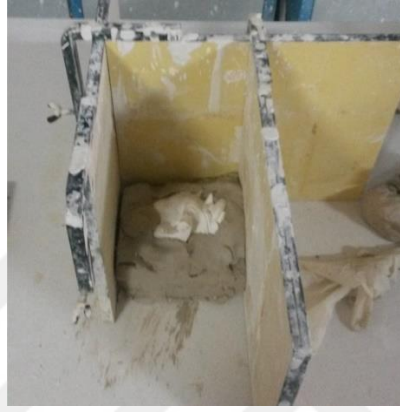
Görsel 3. 12. Refrakter kalıp karışımının dökümü için hazırlanması (Murat Paktur fotoğraf arşivi)
