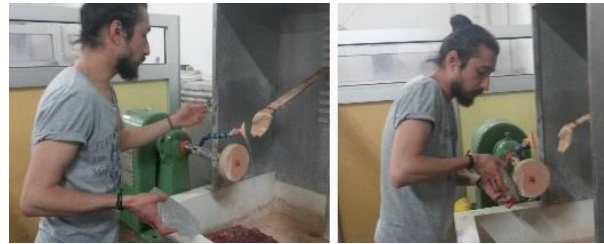
Görsel 3. 19. Seryum uygulaması ile cam yüzeyindeki buğuların giderilmesi (Murat Paktur fotoğraf arşivi)
