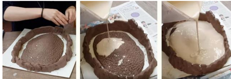
Görsel 1. 9. Kil model kullanılarak “Pate de verre” kalıbı yapımı
