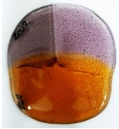
Görsel 3. 8. Uyumsuzluktan kaynaklı cam bünyesinde çatlak oluşumu (Murat Paktur fotoğraf arşivi)
