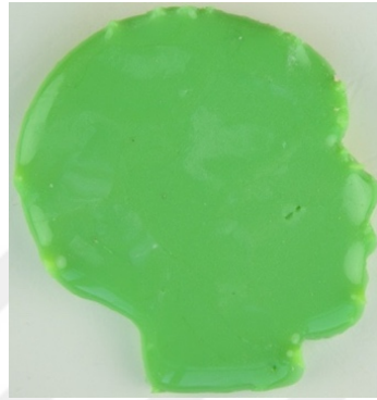
Görsel 4.23. Yeşil renkli camın 750 °C tepe sıcaklığında yapılan ergitme sonrası üstten beyaz ışık altında çekilen fotoğrafı
