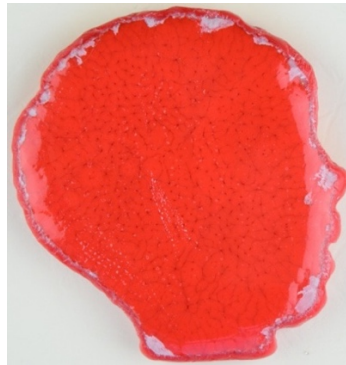
Görsel 4.75. Kırmızı renkli camın 900 °C tepe sıcaklığında yapılan ergitme sonrası üstten beyaz ıřık altında çekilen fotoğrafı (Ayşenur Sarı arşivinden)
