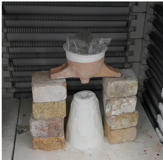
Görsel 2.14. Cam yüklemesi yapılmış seramik potanın yandan görünümü
