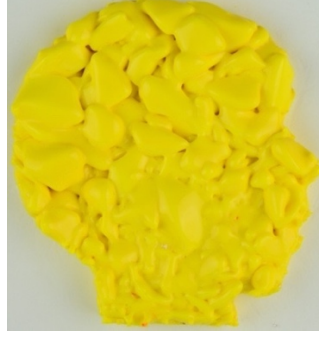
Görsel 4.56. Opak sarı renkli camın 650 °C tepe sıcaklığında yapılan ergitme sonrası üstten beyaz ışık altında çekilen fotoğrafı
