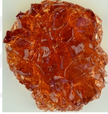
Görsel 4.31. Pembe renkli camın 650 °C tepe sıcaklığında yapılan ergitme sonrası üstten beyaz ışık altında çekilen fotoğrafı
