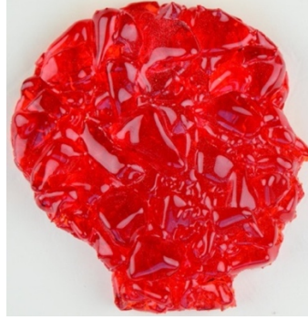
Görsel 4.68. Kırmızı renkli camın 650 °C tepe sıcaklığında yapılan ergitme sonrası üstten beyaz ışık altında çekilen fotoğraf (Ayşenur Sarı fotoğraf arşivinden)
