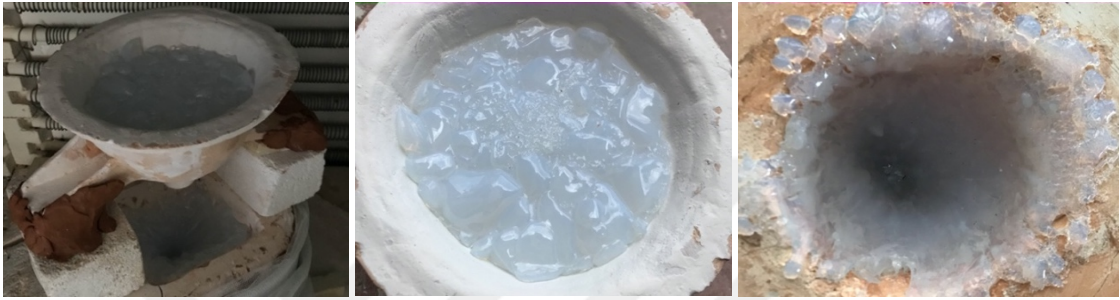
Görsel 4.78. Fırınlama işleminden sonra ve kalıp açılmadan önce elde edilen sonuç (Ayşenur Sarı fotoğraf arşivinden)
