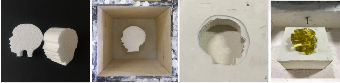
Görsel 4.3. Cam renk denemeleri için oluşturulan kalıplama süreci (Ayşenur Sarı fotoğraf arşivi)
