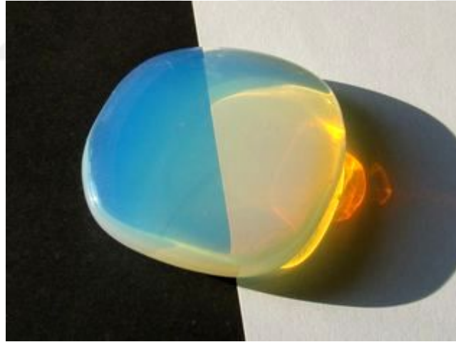
Görsel 1.6. Sütlü cam, kalsiyum fosfat yani kemik külü ( Ca_3(PO_4)_2 ), kriyolit, sodyum heksafloroalüminat ( Na_3AlF_6 ) ya da kalay dioksit kullanılarak üretilir. (http-13)
