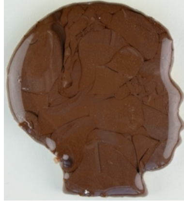
Görsel 4.13. Opak beyaz renkli camın 675 °C tepe sıcaklığında yapılan ergitme sonrası üstten beyaz ışık altında çekilen fotoğrafı
