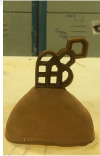
Görsel 2.3. Mum model üzerine eklenen besleme geçidi ve döküm ağız (Ayşenur Sarı fotoğraf arşivi)
