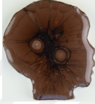
Görsel 4.17. Opak beyaz renkli camın 800 °C tepe sıcaklığında yapılan ergitme sonrası üstten beyaz ışık altında çekilen fotoğrafı
