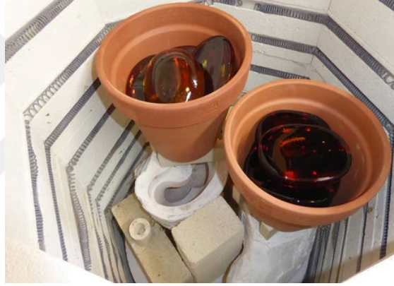
Görsel 2.13. Cam yüklemesi yapılmış seramik pota ( http-44 )
