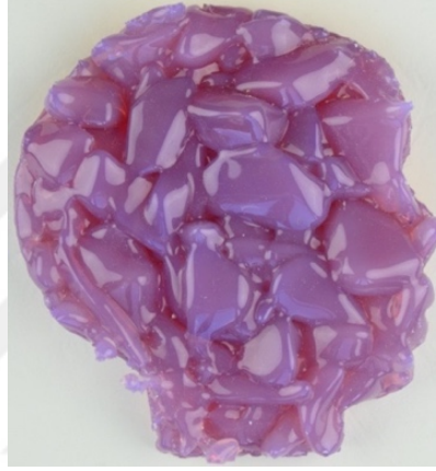
Görsel 4.45. Lila renkli camın 650 °C tepe sıcaklığında yapılan ergitme sonrası üstten gelen beyaz ışık altında çekilen fotoğrafı
