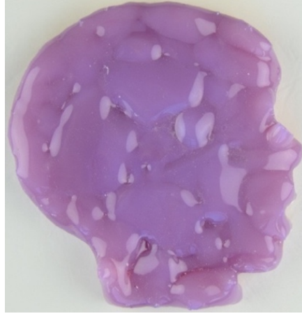
Görsel 4.46. Lila renkli camın 675 °C tepe sıcaklığında yapılan ergitme sonrası üstten beyaz ışık altında çekilen fotoğrafı
