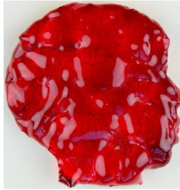
Görsel 4.69. Kırmızı renkli camın 675 °C tepe sıcaklığında yapılan ergitme sonrası üstten beyaz ışık altında çekilen fotoğrafı (Ayşenur Sarı fotoğraf arşivinden)
