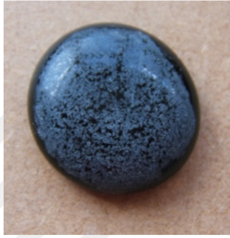
Görsel 1.11. Koyu opal cam üzerinde yüzey devitrifikasyonu ( http-23 )
