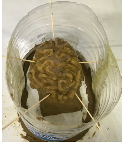
Görsel 4.77. Refrakter kalıp için hazırlanan harcın döküm için hazırlanma süreci (Ayşenur Sarı fotoğraf arşivinden)
