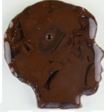
Görsel 4.15. Opak beyaz renkli camın 725 °C tepe sıcaklığında yapılan ergitme sonrası üstten beyaz ışık altında çekilen fotoğrafı
