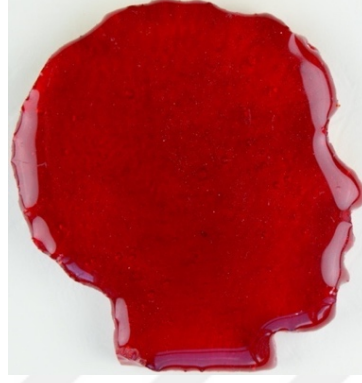
Görsel 4.70. Kırmızı renkli camın 700 °C tepe sıcaklığında yapılan ergitme sonrası üstten beyaz ışık altında çekilen fotoğrafı (Ayşenur Sarı fotoğraf arşivinden)
