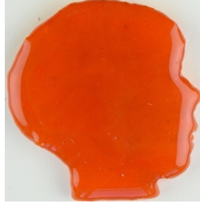
Görsel 4.65. Turuncu renkli camın 750 °C tepe sıcaklığında yapılan ergitme sonrası üstten beyaz ışık altında çekilen fotoğrafı
