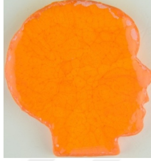
Görsel 4.67. Turuncu renkli camın 900 °C tepe sıcaklığında yapılan ergitme sonrası üstten beyaz ışık altında çekilen fotoğrafı
