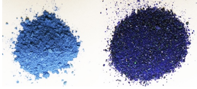
Görsel 1.4. Azuritin (bir çeşit bakır cevheri) tane boyutuna bağlı pigment renginde oluşan değişimi, sağda görünen yeşil azurit çoğunlukla malahit ile birlikte aynı bakır yataklarında oluşmasından kaynaklanır ( http-8 )
