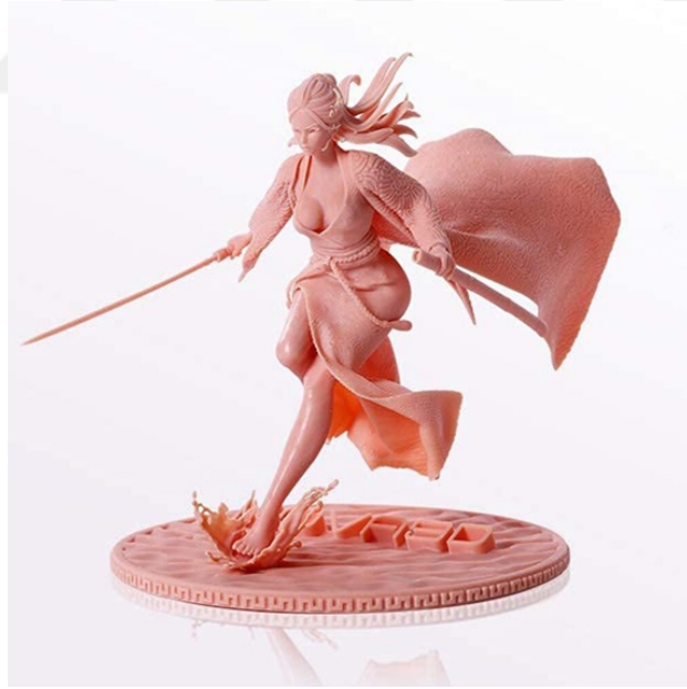
Görsel 2.1. Kırmızı balmumu reçine ile 3D yazıcıda oluşturulmuş model ( http-30 )
