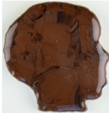
Görsel 4.14. Opak beyaz renkli camın 700 °C tepe sıcaklığında yapılan ergitme sonrası üstten beyaz ışık altında çekilen fotoğrafı
