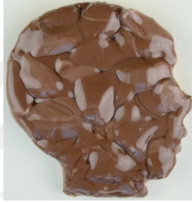
Görsel 4.12. Opak beyaz renkli camın 650 °C tepe sıcaklığında yapılan ergitme sonrası üstten beyaz ışık altında çekilen fotoğrafı
