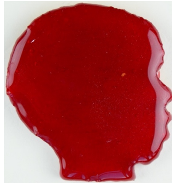
Görsel 4.71. Kırmızı renkli camın 725 °C tepe sıcaklığında yapılan ergitme sonrası üstten beyaz ışık altında çekilen fotoğrafı (Ayşenur Sarı fotoğraf arşivinden)
