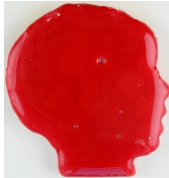
Görsel 4.73. Kırmızı renkli camın 800 °C tepe sıcaklığında yapılan ergitme sonrası üstten beyaz ışık altında çekilen fotoğrafı (Ayşenur Sarı fotoğraf arşivinden)
