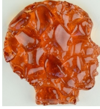
Görsel 4.32. Pembe renkli camın 675 °C tepe sıcaklığında yapılan ergitme sonrası üstten beyaz ışık altında çekilen fotoğrafı
