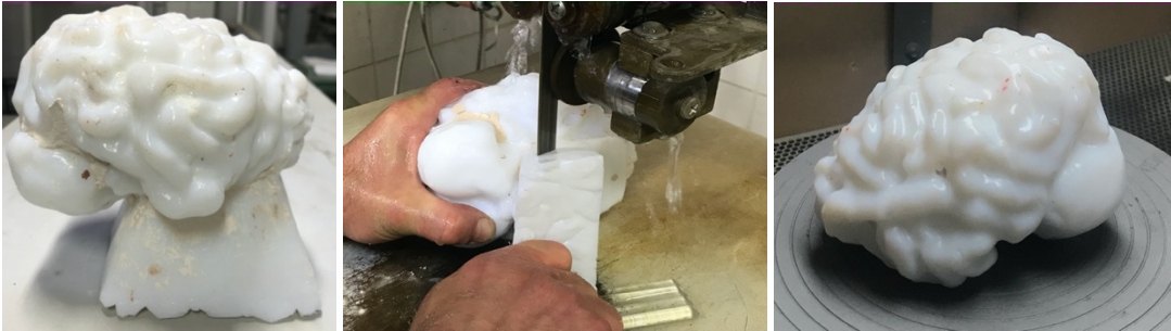
Görsel 4.80. Döküm ağızının modelden temizlenmesi (Ayşenur Sarı fotoğraf arşivinden)
