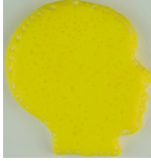
Görsel 4.60. Opak sarı renkli camın 900 °C tepe sıcaklığında yapılan ergitme sonrası üstten beyaz ışık altında çekilen fotoğrafı
