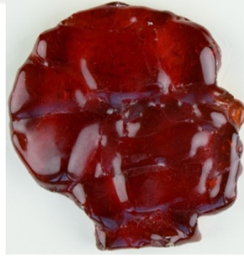
Görsel 4.36. Amber renkli camın 700 °C tepe sıcaklığında yapılan ergitme sonrası üstten beyaz ışık altında çekilen fotoğrafı
