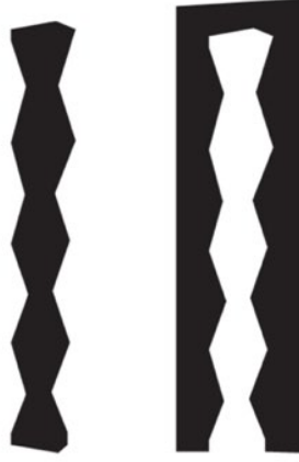
Şekil 2.1. Bir modelin kendisi ve tek parça kalıp alınmış hali ( http-33 )
