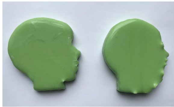
Görsel 4.1. 850 °C tepe sıcaklığında standart diyagram uygulanarak elde edilen cam renk tonu (A) ve 850 °C sıcaklığında ergitilen fakat devitrifikasyon sıcaklık aralığı hızlı geçilerek elde edilen cam renk tonu (B)
