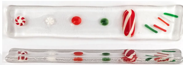
Görsel 2.11. 815 °C'de gerçekleştirilen tam füzyon denemesinin üstten ve yandan görünümü ( http-42 )
