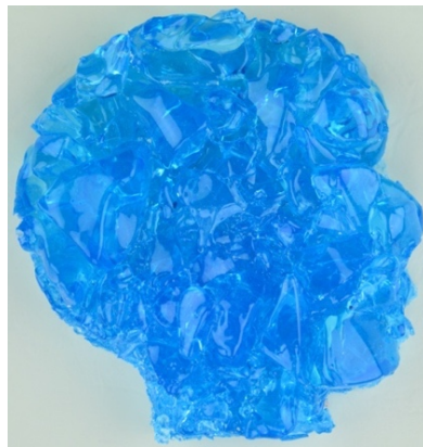
Görsel 4.25. Mavi renkli camın 650 °C tepe sıcaklığında yapılan ergitme sonrası üstten beyaz ışık altında çekilen fotoğrafı
