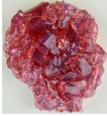
Görsel 4.43. Lila renkli camın 600 °C tepe sıcaklığında yapılan ergitme sonrası üstten beyaz ışık altında çekilen fotoğrafı
