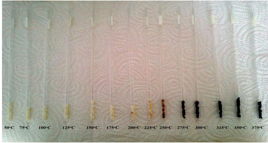
Şekil 5.8 Pyrex ESR tüplerine yerleştirilmiş sütlaç örnekleri.
