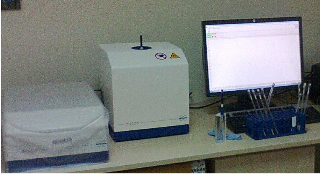
Şekil 5.4 DEÜ Fizik bölümündeki Bruker e-scan X-bant ESR spektrometresi.
