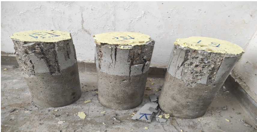
(a) B1 kirişine ait silindir numunelerin tek eksenli basınç testi sonrası durumu
