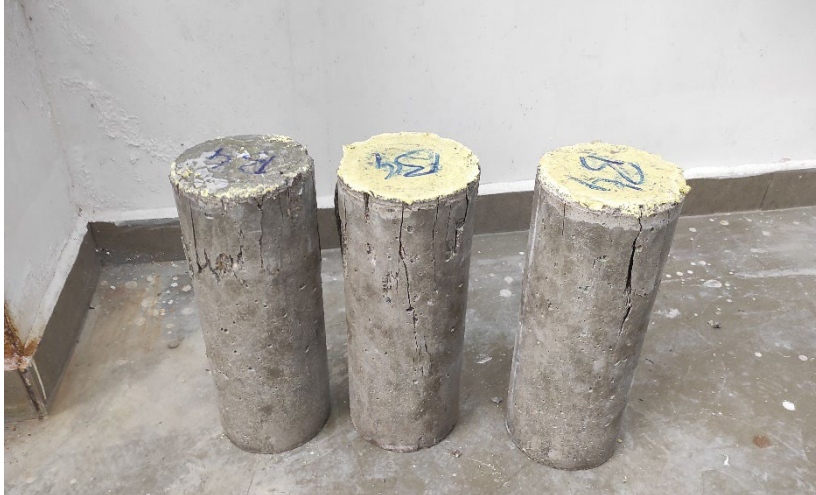
(ç) B4 kirişine ait silindir numunelerin tek eksenli basınç testi sonrası durumu
