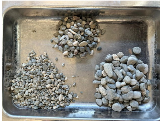
Şekil 3.3. Betonarme kirişlerin karışımlarında kullanılan malzemeler
