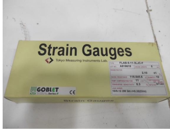
Şekil 3.9. FLAB-5-11-3LJC-F tipi birim deformasyon ölçerler (Strain Gauge)
