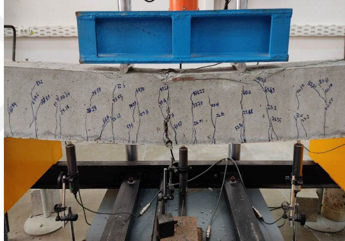
(b) B4 kirişinin kırıldıktan sonraki durumu (ön görünüş)
