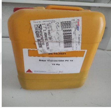
řekil 3.5. Betonarme kiriř karıřımında kullanılan akıřkanlařtırıcı
