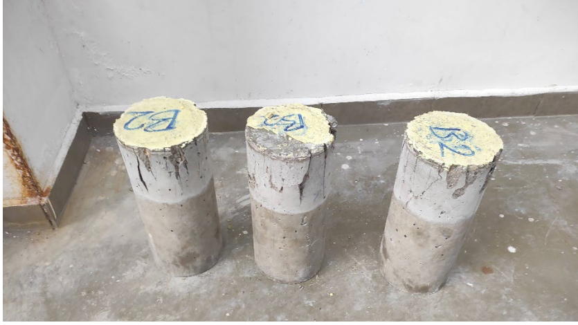
(b) B2 kirişine ait silindir numunelerin tek eksenli basınç testi sonrası durumu
