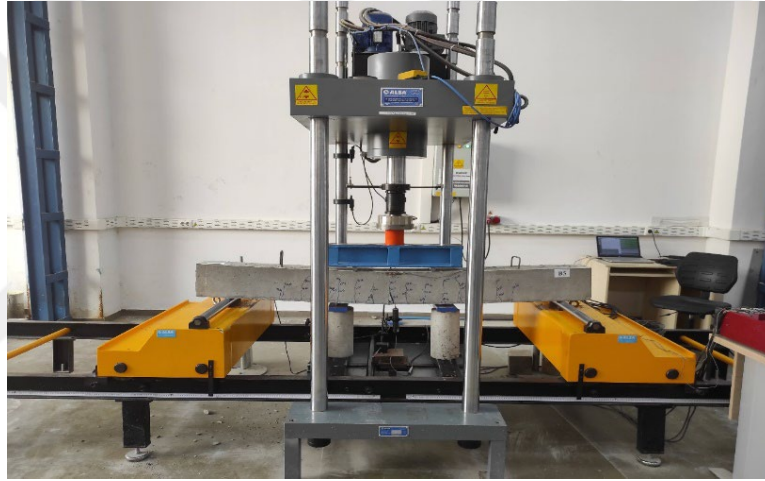
(b) B5 kirişinin kırıldıktan sonraki durumu (ön görünüş)
