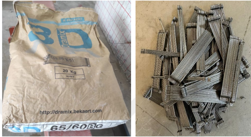
Şekil 3.4. Betonarme kiriş karışımında kullanılan 3D 65/60 çelik lif
