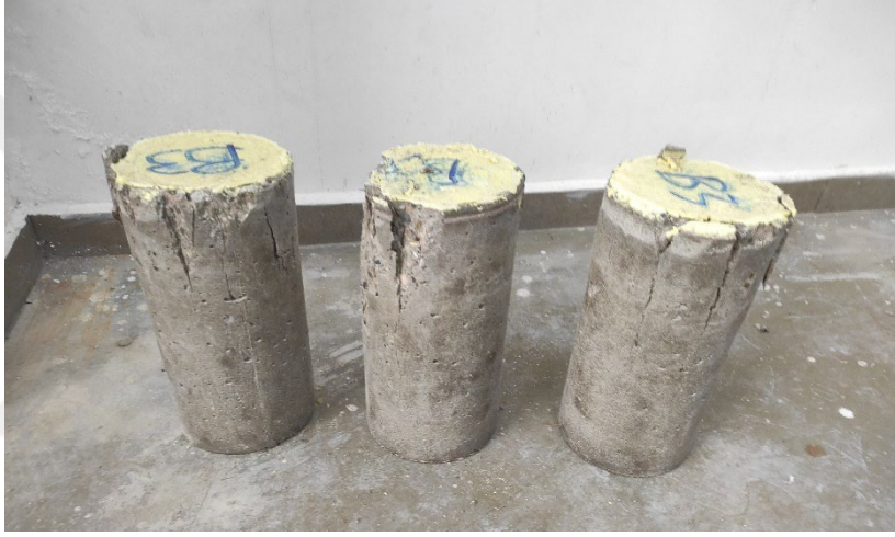
(c) B3 kirişine ait silindir numunelerin tek eksenli basınç testi sonrası durumu
