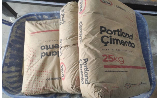
Şekil 3.1. CEM I 42.5R sınıfı çimento
