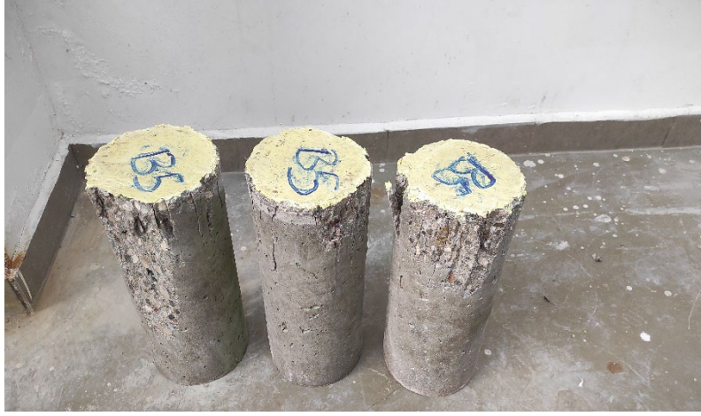
(d) B5 kirişine ait silindir numunelerin tek eksenli basınç testi sonrası durumu
