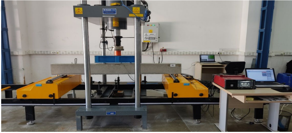
(a) B1 kirişinin kırılmadan önceki durumu
