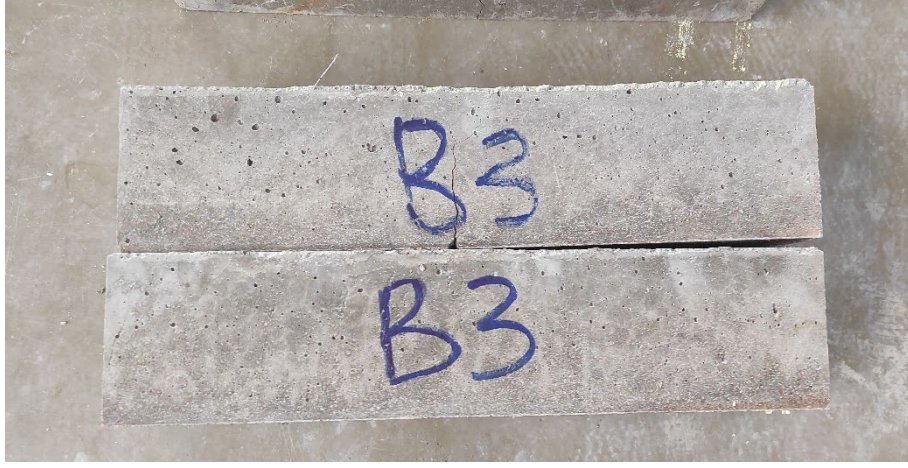
(c) B3 kirişine ait prizma numunelerin eğilmede çekme testi sonrası durumu
