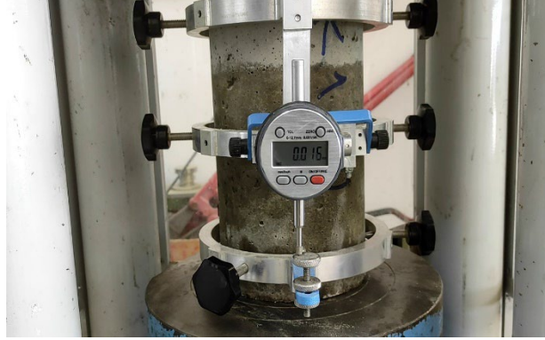
Şekil 3.17. Silindir numunelere basınç deneyi uygulanması
