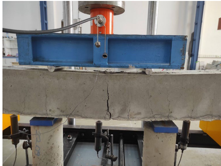
(c) B5 kirişinin kırıldıktan sonraki durumu (arka görünüş)
