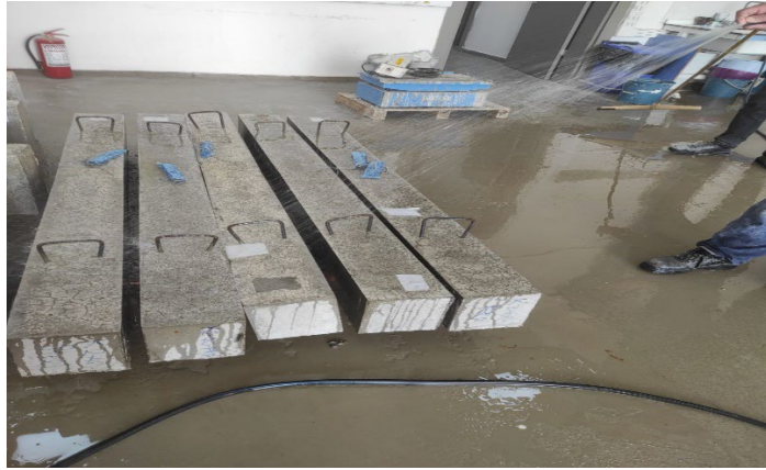
(j) Kiriş numunelerinin kalıptan çıkarılıp sulanması
