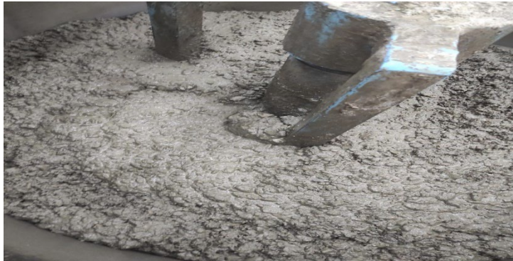
(b) Su ve çimentonun eklenip karıştırılması
