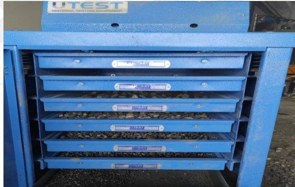
Şekil 3.2. Agregaların otomatik elek yardımıyla gradasyonlarına ayrılması
