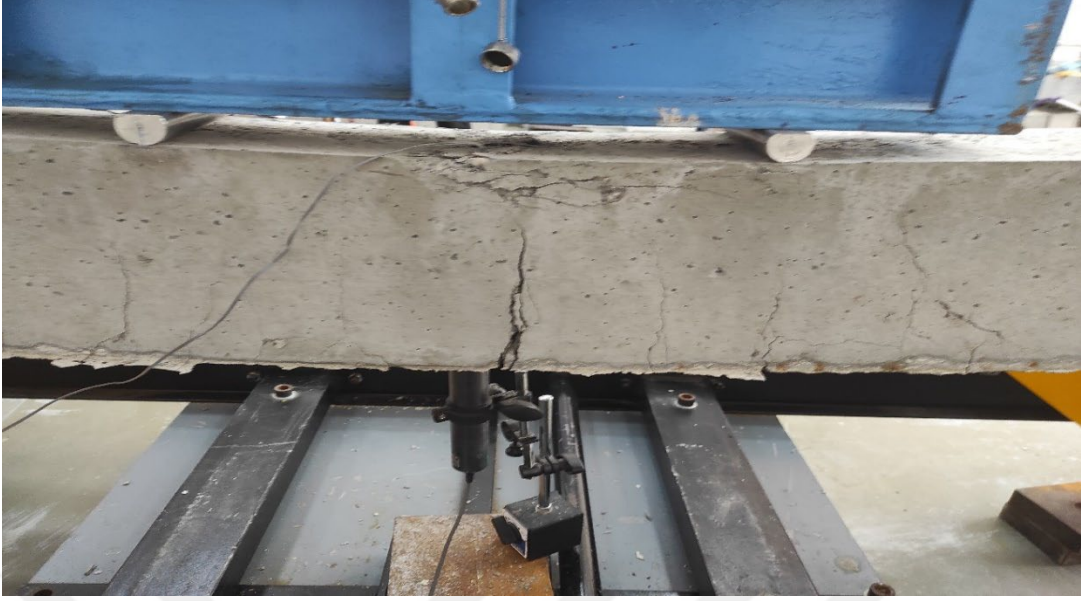
(c) B2 kirişinin kırıldıktan sonraki durumu (arka görünüş)
