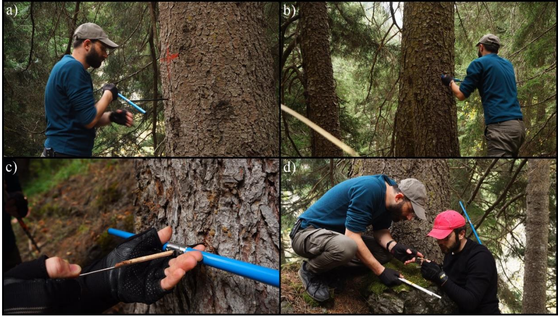
Şekil 2.3. Araziden örnek alım süreci: a) Ağacın A yönünden örnek alımı, b) B yönünden örnek alımı, c) artım kaleminin çıkarılması, d) örneğin göreceli sayılması.
