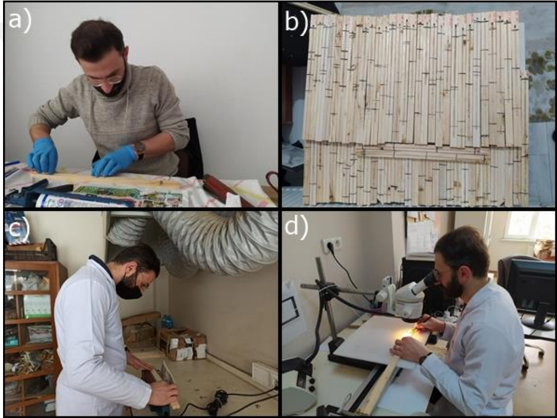
Şekil 2.5. Artım kalemlerinin tutkalla yapıştırılması (a), lastikle tutturulması (b), zımparalanması (c) ve seksiyonlara ayrılması (d).
