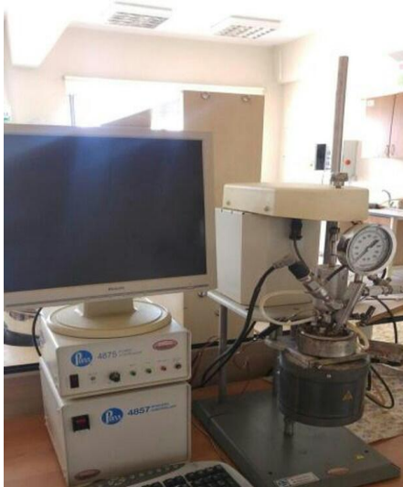
Şekil 3.2. Kullanılan basınç reaktörü sisteminin görünümü
