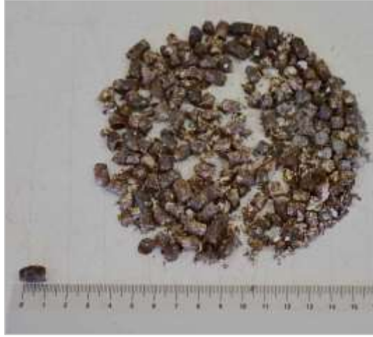
Şekil 4.7. Taş mastik asfalt karışımlarında kullanılan selülozik fiber katkısı
