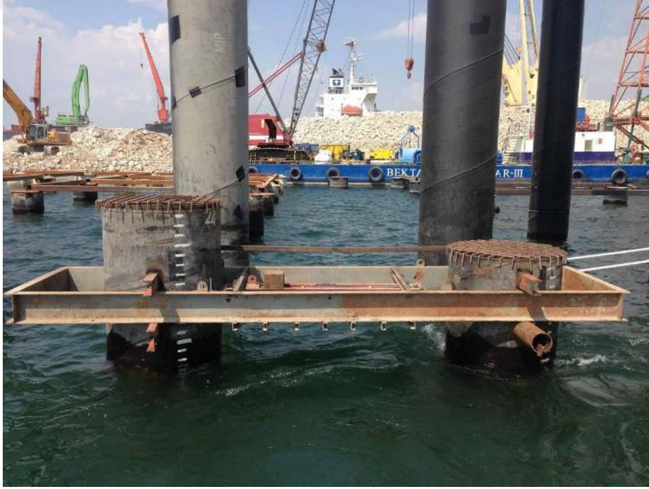
Şekil 3.15. Yanal Yükleme Deney Düzeneği
