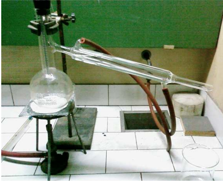
Resim 3.1. Atık alkolün geri kazanımı için kurulan distilasyon düzeneğinin fotoğrafı
