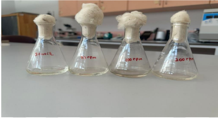
Şekil 4.10. Farklı çalkalama hızlarında üretilen AgNP oluşumuna bağlı renk değişimi.
