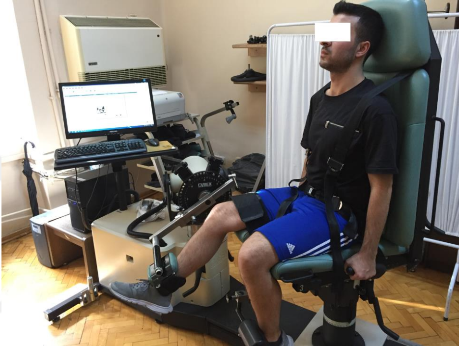
řekil 3-7: İzokinetik kuvvet ve dayanıklılık ölçümü
