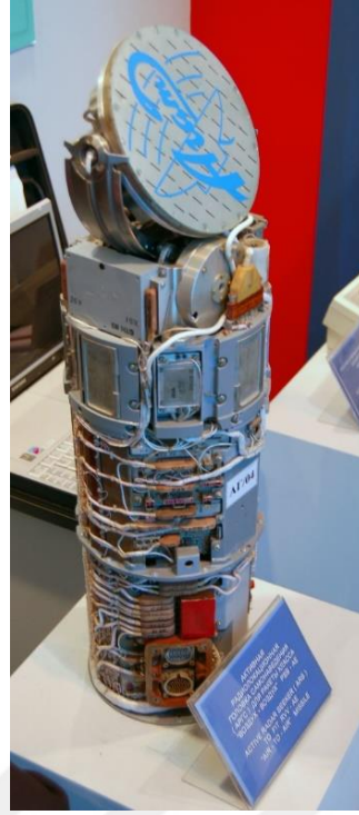
Şekil 3.1. Aktif RF arayıcı başlık bütünü iç kısım görseli
