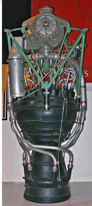
Şekil 1.2. V-2 füzesinin motoru (Bowdoin, 2000).
