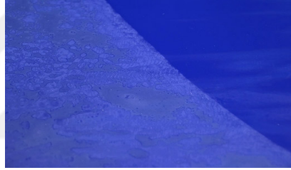
Görsel 4.5. Devitrifikasyon örneği https://www.bullseyeglass.com/what-is-devitrification-or-devit.html (Erişim tarihi: 21.02.19)
