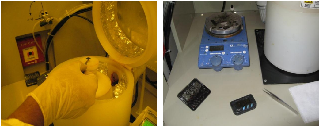
Şekil 5.8. Fotorezist kaplanan numuneye ısıtılma uygulama süreci
