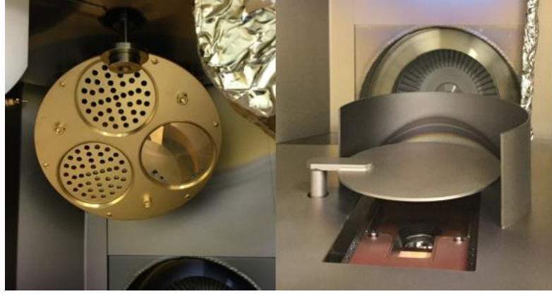
Şekil 3.10. Elektron demet buharlaştırma sisteminin haznesinde bulunan, değişik açılarda durabilen ve gezegensel dönüş yapabilen örnek tutucu (solda) ve malzemenin buharlaştığı pota (sağda) görülmektedir.
