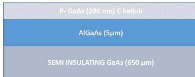
Şekil 3.2. P-kontak çalışması yapılan epi-katman yapısı
