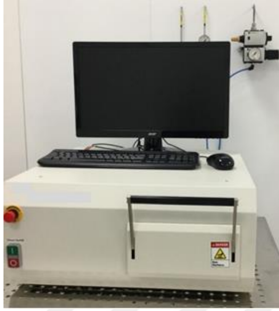
Şekil 3.11. K-tipi ısılcıft ile sıcaklık ölçümü yapan hızlı ısıt işlemci.
