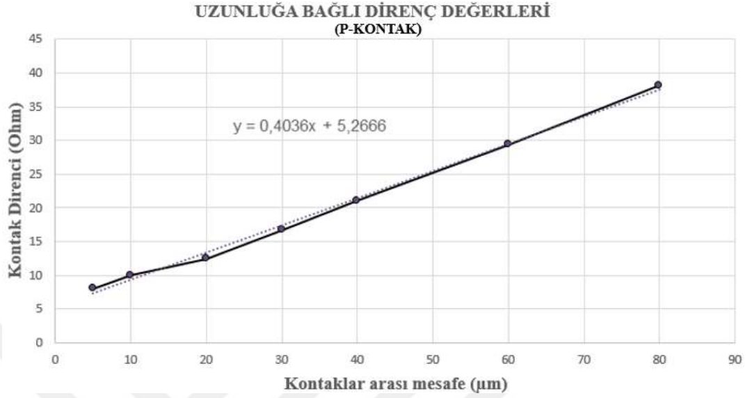
Şekil 4.2. Tavlanmış p-kontağa ait mesafe-direnç grafiğinde gösterilen noktalar doğrunun üzerinde veya doğrunun çok yakınında bulunmaktadır. Akım kontaklar arasında yarı iletkenin yüzey direncinden başka bir dirençle karşılaşmadığı için grafik doğrusal ve farklı noktalarda tutarlıdır.
