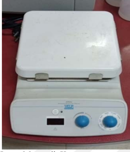
Şekil. 3.11. Elektrikli Isıtıcı Manyetik Karıştırıcı
