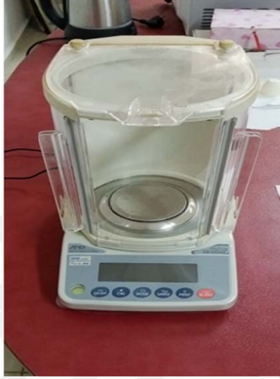
Şekil. 3.8. Precisa XB 220 A marka dijital hassas terazi
