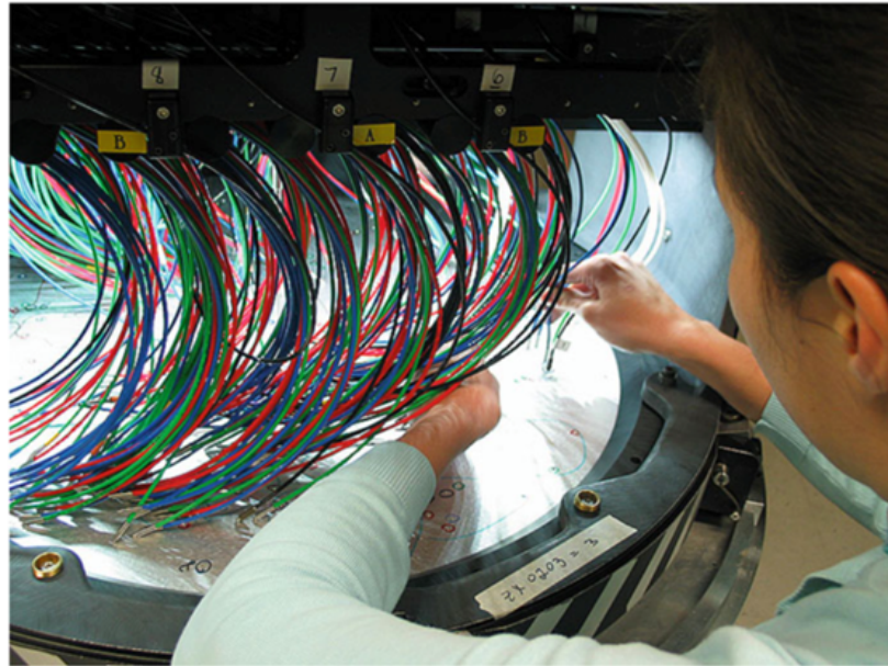
Şekil 2.18: Tayfçeker ve Sloan Teleskobu'nun odağına monte edilecek olan metal plaka arasındaki fiber kabloların bağlanması 2 .
