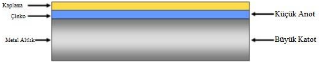
Şekil 2.11. Kesme kenarında alan etkisi (Lezzi, 2011).
