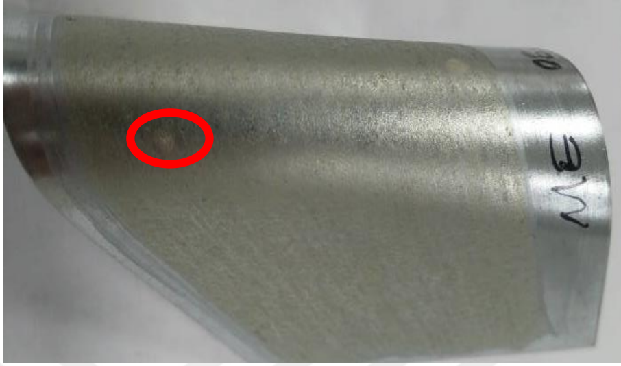
Şekil 4.3. Mikro ZnO partikül katılan numunede bükme testi sonrası oluşan çok küçük ayrılma görüntüsü.
