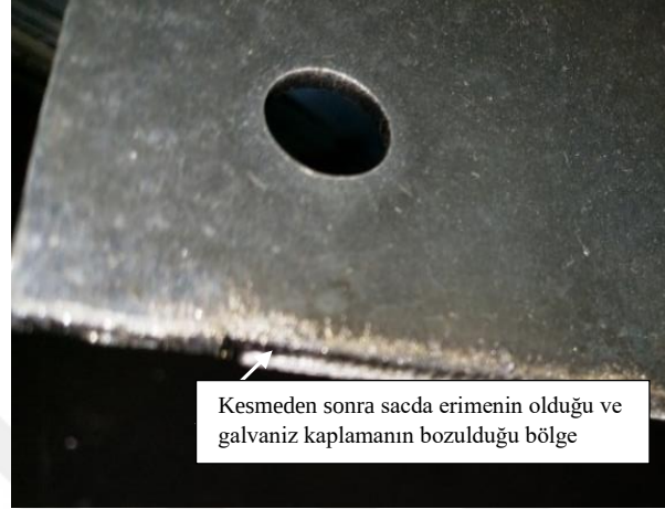
Şekil 2.16. Termal kesim işlemi sonrasında sacdaki galvaniz kaplamanın etkilenmesi.
