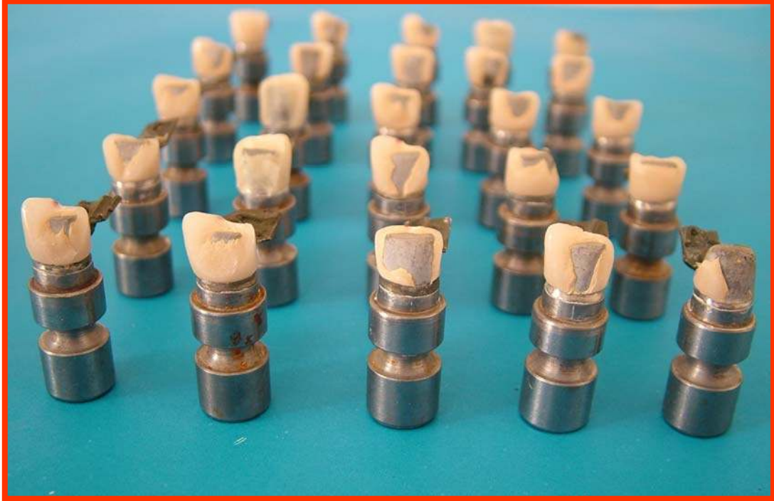
Şekil 4.10 : Yüklemeden sonra Ni- Cr örneklerde oluşan deformasyonların görüntüsü
