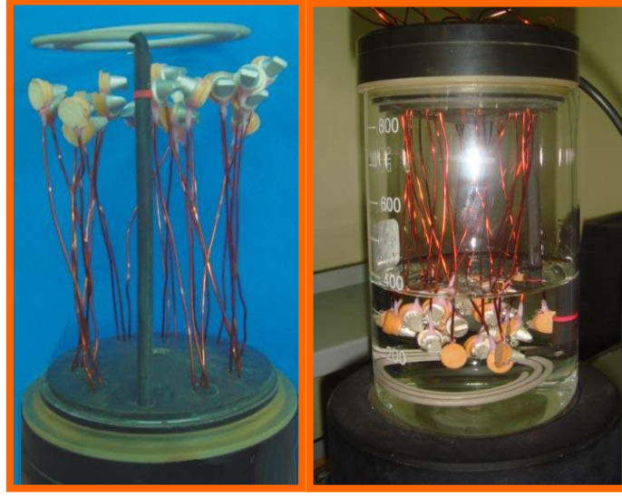
Şekil 3.12 : Örneklerin, yükleme kafasına bağlandıktan sonraki ( solda) ve banyodaki görüntüsü (sağda)
