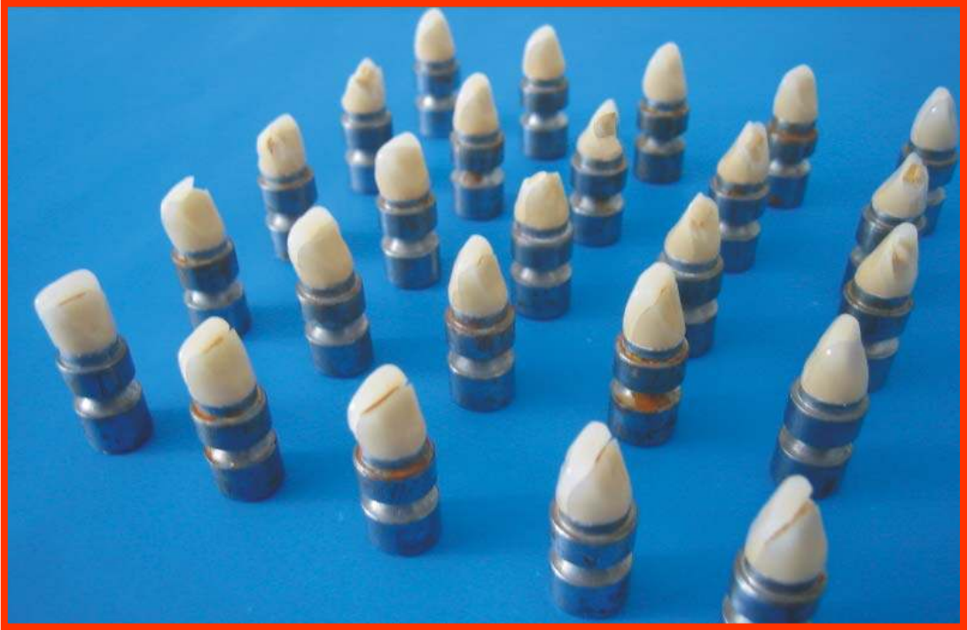
Şekil 4.12 : Yüklemeden sonra Galvano-seramik örneklerde oluşan deformasyonların görüntüsü
