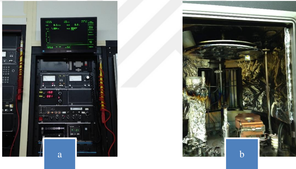
řekil 3.2: a) Elektron demeti ve b) puskurtme yntemleri ile kaplama cihazları
