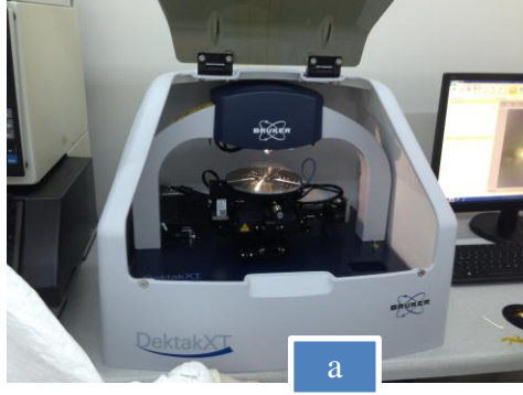
Sekil 3.11 : a) Mekanik profilometre ve b) Örnek ölçüm görüntüsü
