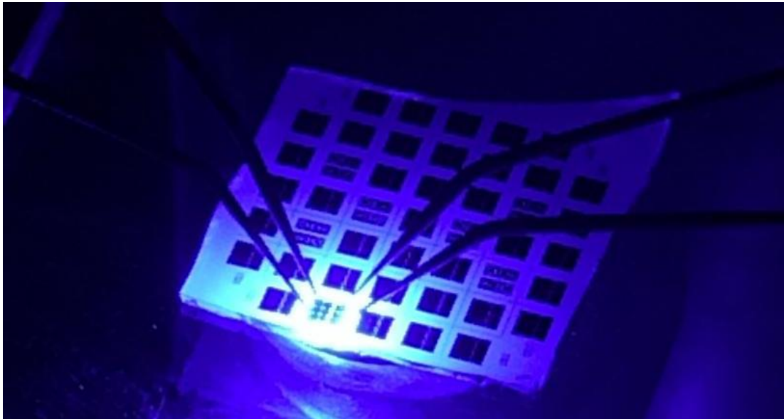
Şekil 2.2 : Fabrikasyonu bu tez kapsamında yapılmış mavi ışık yayan galyum nitrür (GaN) LED çip
