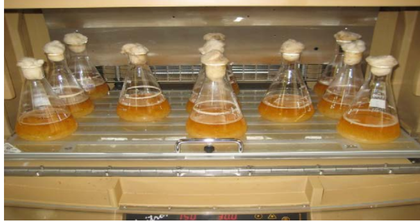
Şekil.3.2. G. lucidum peletlerinin etüvde üretim aşaması
