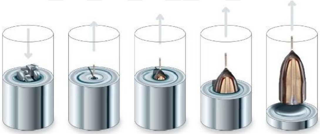
Şekil 2.1. Czochralski büyütme metodunun şeması
