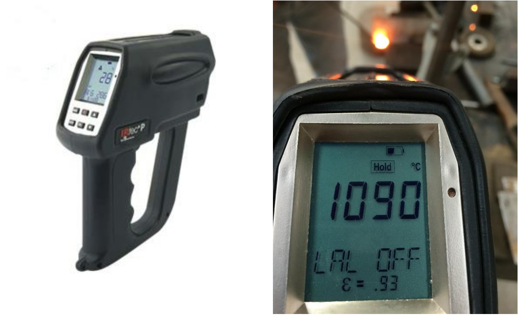
Şekil 4.4 IRtec P2000 Mk2 sıcaklık ölçüm cihazı.
