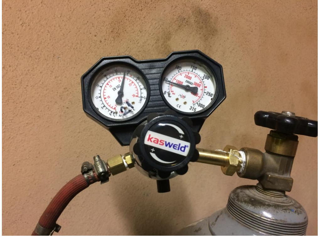
Şekil 2.5 Gazaltı ark kaynağı koruyucu gaz tüpü ve donanımları.
