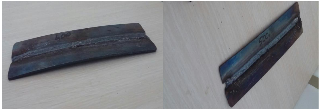
Şekil 4.5 Alın kaynağı sonrası örnek numuneler.
