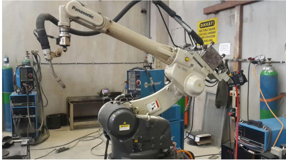
Şekil 4.2 Panasonic TGA1900G2 kaynak robotu.
