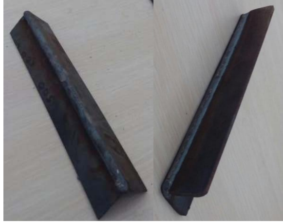
Şekil 4.9 Deneysel çalışmada köşe kaynak uygulama örnekleri.
