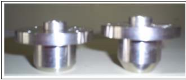
Resim 4.7. Deneylerde kullanılan çıkıntı aparatları ( h=2 mm ve h=6 mm )
