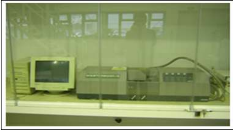
Resim 4.9. Malvern Mastersizer E parçacık boyutu ölçme cihazı
