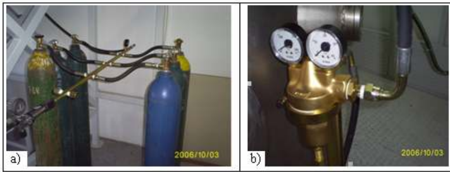
Resim 4.2. Gaz sisteminde kullanılan ekipmanlar a) Yüksek basınçlı tüpler b) Basınç ayar vanası
