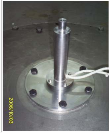
Resim 4.6. Akış memesi-çıkıntı aparatı - nozul bağlantısı
