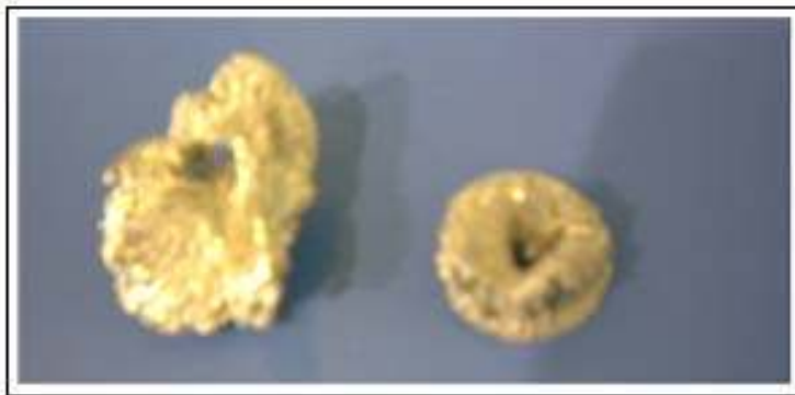
Resim 5.1. Nozul çıkıntı ucunda meydana gelen metal yığılmaları
