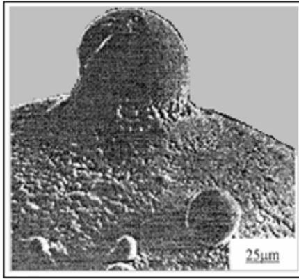
Şekil 3.15. Bir toz yüzeyindeki uydu tozlar [1].
