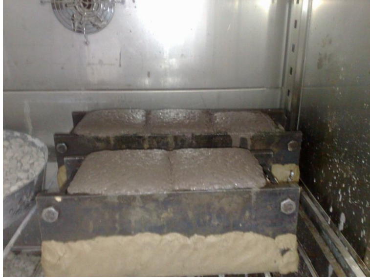
Resim 2.3 Akıcı kıvamda gazbeton harcının kabarmasıyla kalıbı doldurması.
