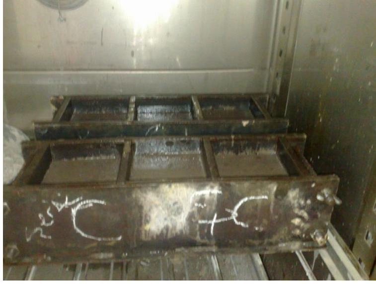
Resim 2.2 Sulu kıvamda gazbeton harcı kalıbın 2/3'ü dolacak biçimde dökülür (kabarma oluşmadan önce).
